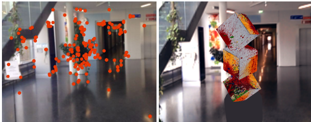
Abbildung 2. Markerless 3D-Tracking: Punktwolken (links), Tracking und Anzeige eines virtuellen Objektes (rechts).
