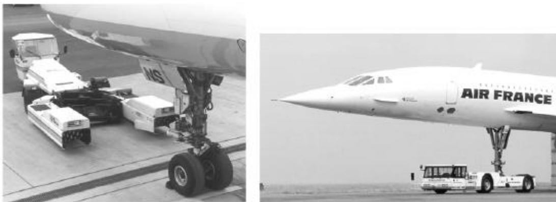
Bild 38 Flugzeugschlepper: Selbstverstärkende Lösung des Zugkraftproblems. Die zu ziehende Last trägt zum Reibungsgewicht der Zugmaschine bei.
