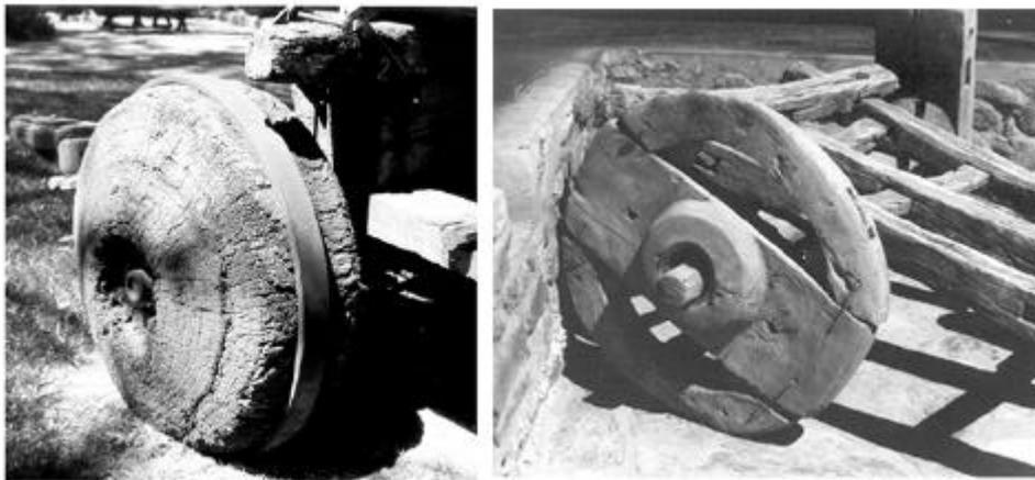
*Bild 40* Wo man sich mit einfachsten Mittel behelfen musste, entstanden solche ein- oder mehrteilig aus Holz gefertigte Räder. Links: Einteiliges Holzrad mit Eisenbandage, rechts: mehrteiliges Holzrrd (unbandagiert) im argentinischen Hochland (Molinos, Provinz Salta)
