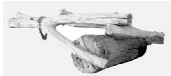
Bild 6 Einfache Planierwalze aus Holz zum Ebnen von Feldern (Australien)
