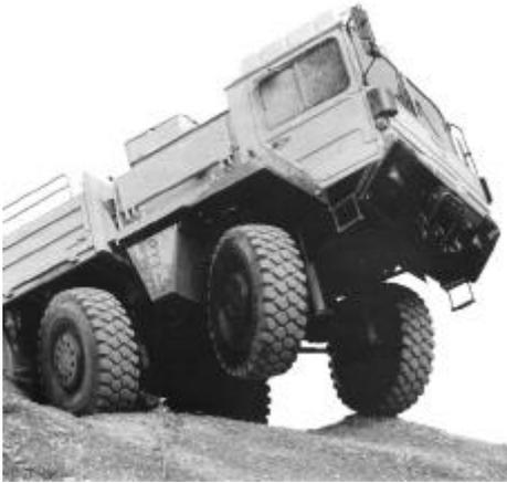
*Bild 26 Kraft- und formschlüssige Kraftübertragung: Geländereifen eines Kfz mit Stollenprofil*
