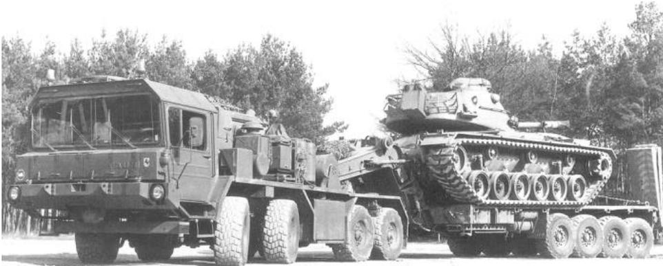
*Bild 39 MAN-Panzerschlepper. Auch hier trägt die zu ziehende Last zum Reibungsgewicht der Zugmaschine bei*
