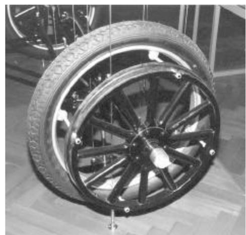
*Bild 52 Kfz-Rad, demontierbar*
