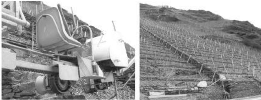
Transportfahrzeug mit Antrieb durch Zahnrad und Zahnstange an einem Weinberg an der Mosel.
