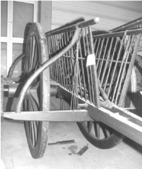
*Bild 17 Diese Wasserbüffelkarre aus Thailand (Amphur Panasnikom, Provinz Chonburi) dient zum Transport von Ackergeräten und Reis. Wegen des weichen Untergrundes mussten die Räder groß genug gestaltet werden, um ein Vorwärtskommen überhaupt zu ermöglichen. Dieses Exemplar ist im Classic Center der Mercedes-Benz in Fellbach ausgestellt.*
