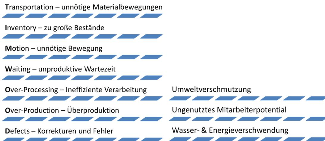
Abbildung 17: Verschwendung im Produktionsprozess „Tim Wood +“
