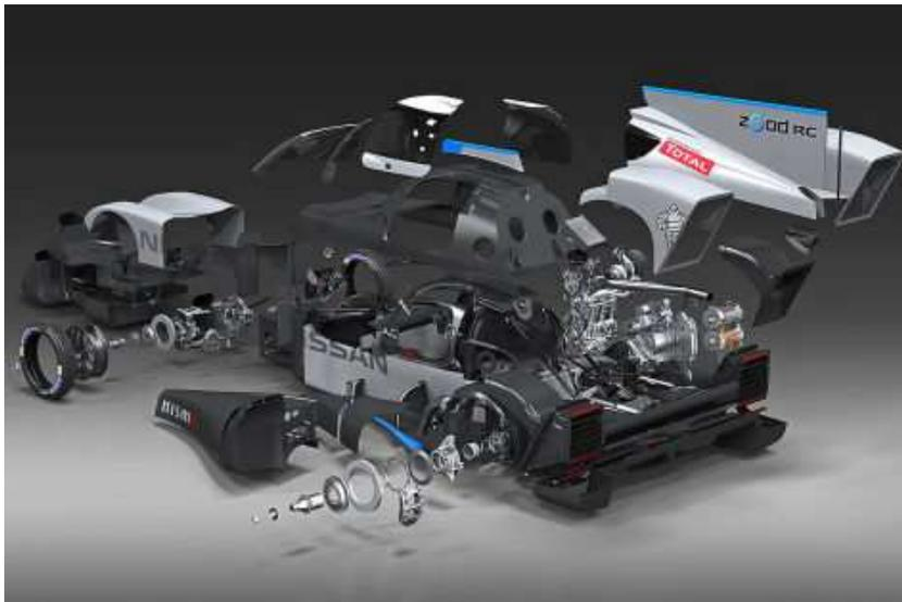
**Abbildung 4.2:** Explosionszeichnung eines Nissan ZEOD RC, die von Nissan anlässlich des Rennens von LeMans 2014 veröffentlicht wurde. Quelle: *Auto Bild* (<https://www.autobild.de/artikel/nissan-zeigt-le-mans-renner-als-explosionszeichnung-5132584.html>)
