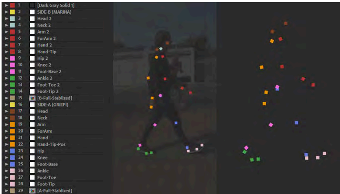
Abbildung 5.5: Links die Liste aller erfassten Marker, mittig und rechts die Visualisierung der extrahierten Markerpositionen.
