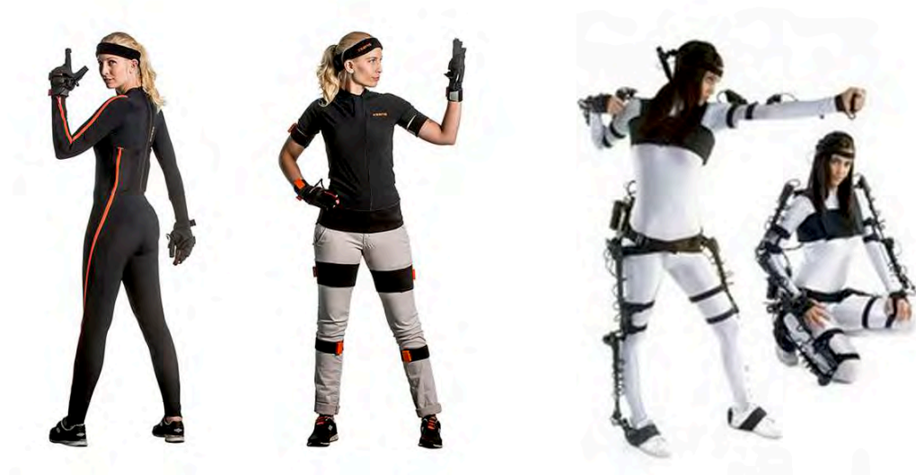
Abbildung 3.11: Links: Inertialsensoren Systemen von XSens ( https://www.xsens.com/news/new-software-release-mvn-animate-mvn-analyze-2018-2/ Stand: 20.05.2019) Rechts: Mechanisches Motion Capture System (Das Originalbild wurde zugeschnitten, sodass die Frau auf dem Bild nur noch 2 mal zusehen ist. http://www.pccpolska.pl/motion-capture-co-powinienes-wiedziec-o-systemach-mocap/ Stand: 20.05.2019)
