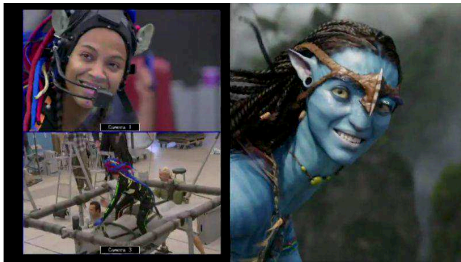
Abbildung 1.1: Drei Bilder, die den Einsatz von Performance Capture im Film Avatar zeigen. Links oben sieht man die Kamera, mit der die Mimik des Darstellers aufgezeichnet wird, links unten ein großes Motion Capture Set, das die Bewegungen während des Fluges einfängt und auf der rechten Seite den fertigen Filmausschnitt aus der selben Szene. ( http://kgrdoss.tripod.com/blog/Avatar.htm Stand: 14.03.2019)
