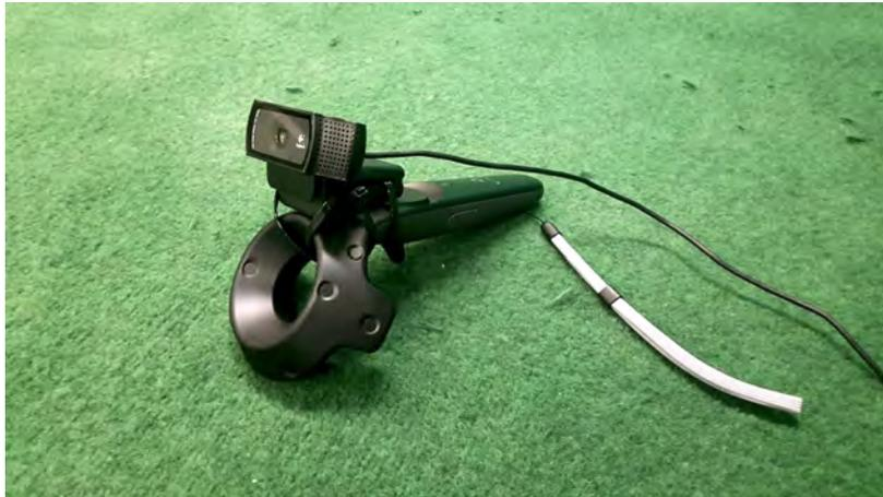
**Abbildung 3.13:** Die Abbildung zeigt eine normale Webcam, die mit Kabelbindern an einen Vive Controller befestigt wurde
