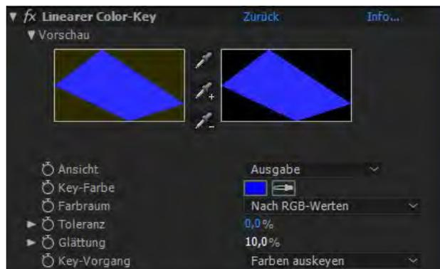
**Abbildung 2.9:** Die Einstellungsmöglichkeiten für den *After Effects*-Effekt „Linearer Color-Key“.
