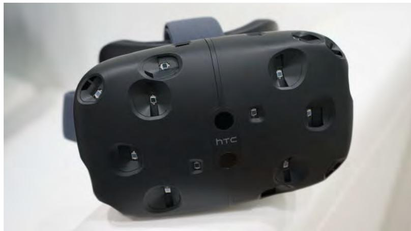
**Abbildung 3.5:** Zu sehen ist ein Prototyp des *HTC Vive* VR-Headsets bei dem die Sensoren nicht abgedeckt sind.
