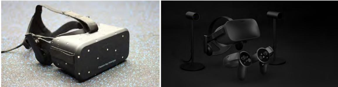
**Abbildung 3.2:** Links ist ein *Oculus Rift*-Prototyp mit sichtbaren Infrarot-LEDs abgebildet. Rechts ist die *Oculus Rift* mit den Infrarot-Kameras (hinten) und den zugehörigen Controllern (vorne) zu sehen.
