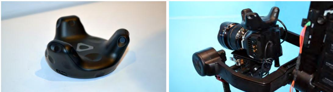
**Abbildung 3.7:** Links ist der *Vive Tracker* zu sehen. Er besitzt, so wie das *Vive Headset* und die *Controller*, mehrere *Photodioden*, die zur *Positionsbestimmung* verwendet werden. Rechts ist der *Vive Tracker* auf einer *Kamera* befestigt abgebildet.
