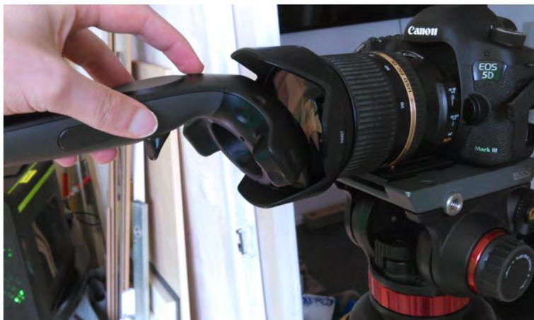
**Abbildung 5.8:** Zu sehen ist, wie eine Motion Controller der Vive verwendet wird, um die Position der realen Kamera zu bestimmen.
