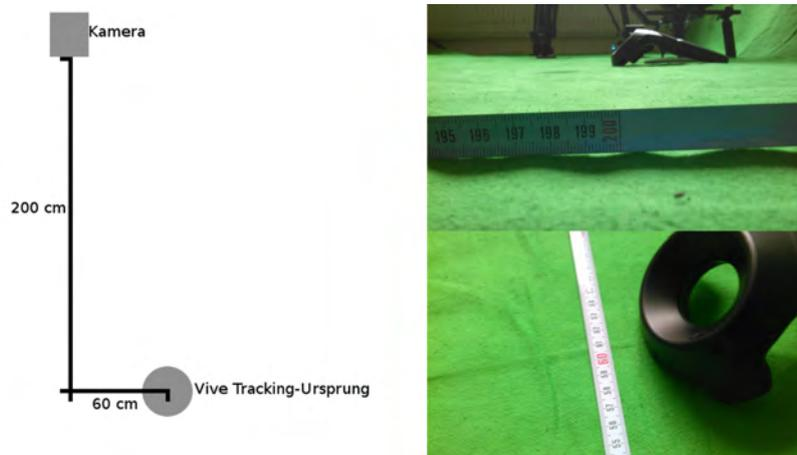
**Abbildung 5.17:** Abgebildet ist die Vermessung der Kameraposition sowie eine Skizze die diese darstellt.
