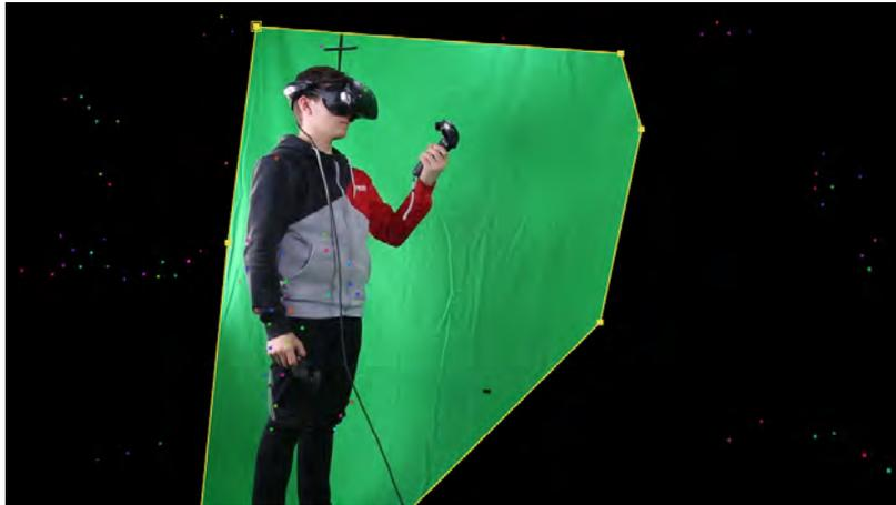
**Abbildung 5.20:** Zu sehen sind von After Effects Kameratracker gefundene Tracking-Punkte, die sich zum Teil auf dem VR-Anwender befinden. Außerdem ist die Maske zu sehen, die die Bereiche neben dem Greenscreen, die Markierungen und das Stativ ausblendet.
