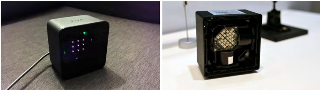
**Abbildung 3.4:** Links ist ein eingeschaltetes *Lighthouse* zu sehen, dessen LEDs und Laser mit Hilfe einer Kamera sichtbar werden. Rechts ist ein geöffneter *Lighthouse*-Prototyp abgebildet. Rechts und Unten im *Lighthouse* befinden sich die rotierenden Laser und in der Mitte die LEDs.
