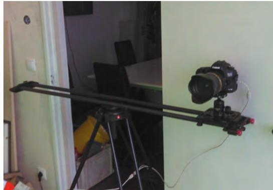
**Abbildung 5.14:** Der verwendete Kameraslider auf einem Stativ montiert mit befestigter Kamera, bevor mit der Aufnahme begonnen wurde.
