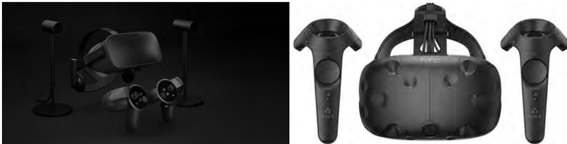
**Abbildung 1.2:** Links ist die *Oculus Rift* zu sehen, mit den zugehörigen Tracking-Kameras rechts und links vom Headset und davor sind die *Oculus Touch Controller* abgebildet. Rechts ist die *HTC Vive* mit den zugehörigen Controller abgebildet.
