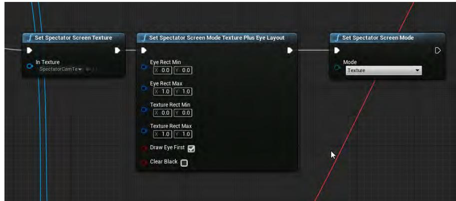
**Abbildung 5.3:** Nodes zum Anzeigen des VR Spectator Screens, die in der LevelBlueprint ausgeführt werden.
