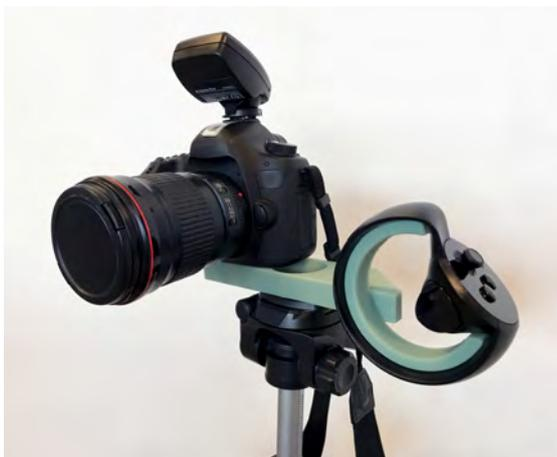
**Abbildung 3.14:** Es ist ein *Oculus Touch Controller* zu sehen, der mit Hilfe einer 3D gedruckten Befestigung an einer DSLR-Kamera befestigt wurde. Die 3D-Datei für die Befestigung stellt *Oculus VR* frei zur Verfügung.
