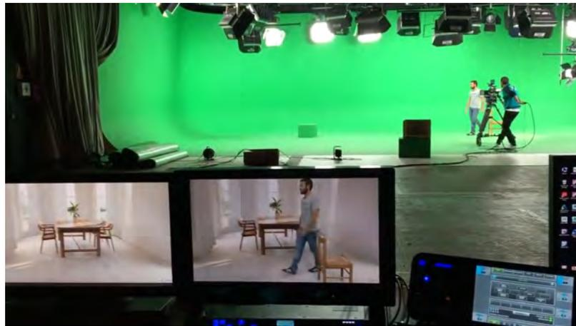
**Abbildung 3.12:** Ein Screenshot aus einem Testvideo von On-Set Facilities, der einen Echtzeit-Compositing Test zeigt. Auf den Bildschirmen im Vordergrund ist auf dem linken Bildschirm der virtuelle Hintergrund aus der Unreal Engine und auf dem zentralen Bildschirm das Compositing von virtuellem Hintergrund und realem Vordergrund zu sehen.
