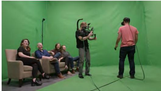
**Abbildung 1.3:** Eine Kamera wird für eine Mixed Reality-Aufnahme mit einem Controller der *HTC Vive* getrackt. Der Controller ist oberhalb der Kamera montiert.
