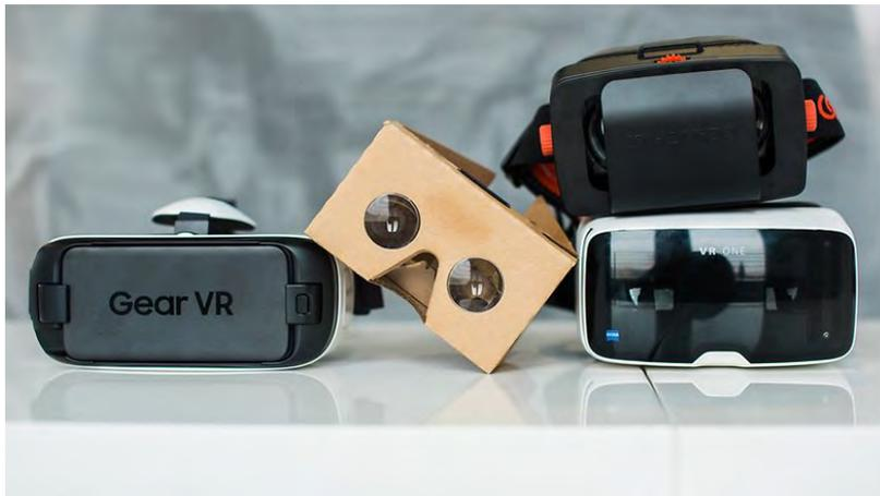
**Abbildung 2.1:** Verschiedene VR-Headsets für Smartphones. Abgebildet sind rechts die *Samsung Gear VR*, in der Mitte das *Google Cardboard*, links oben ein *Homido VR Headset* und links unten die *Zeiss VR One*
