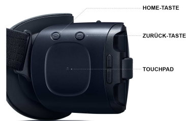
Abbildung 3.7: Seitliche Ansicht von Samsung Gear VR. Es sind drei Bedienmöglichkeiten zu erkennen, die Zurück-Taste, ein Touchpad und die Home-Taste.
