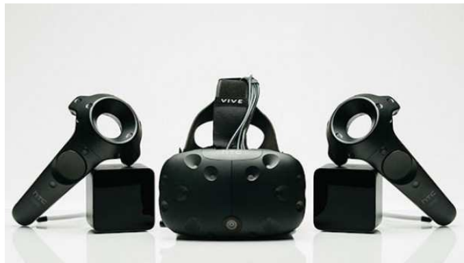
Abbildung 3.10: Diese Abbildung zeigt das gesamte Equipment HTC Vive Familie. Zwei Controller, zwei raumvermessende Sensoren und das HMD. Quelle: HTC Vive
