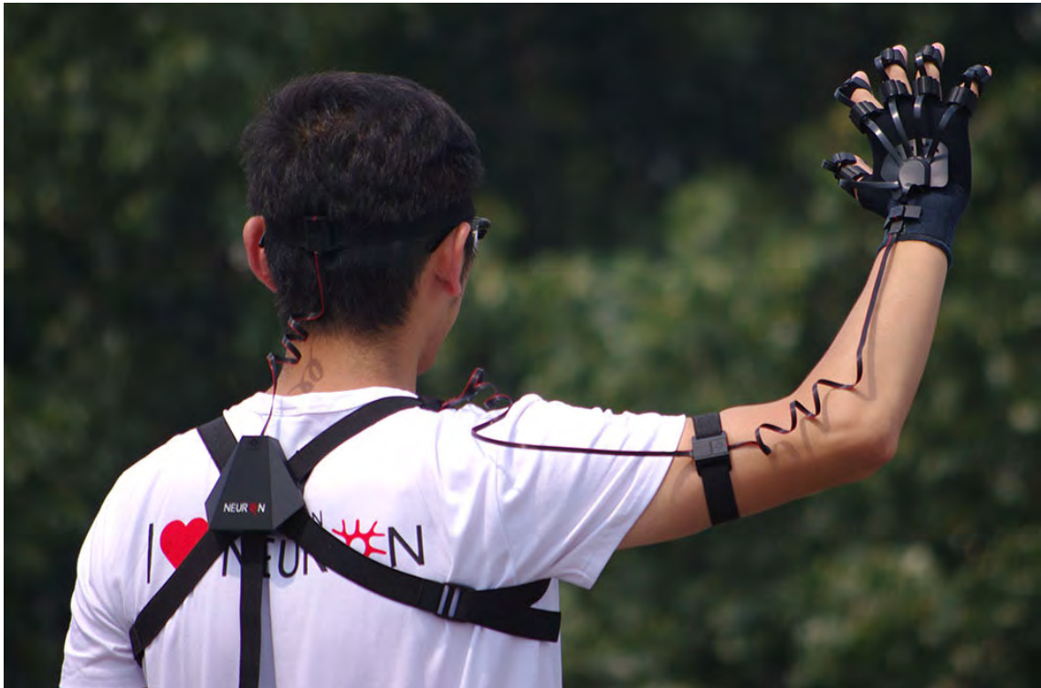
Abbildung 3.3: Die Auf Inertialsensoren basierende Perception Neuron Prototyp Hardware im Einsatz.
