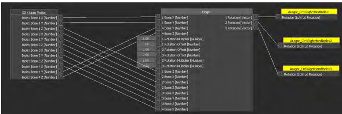
Abbildung 5.15: Aufbau des Constraint-Abschnitts zur Interpretation der Fingerdaten mittels Makro und die Übertragung dieser auf FK-Controls.
