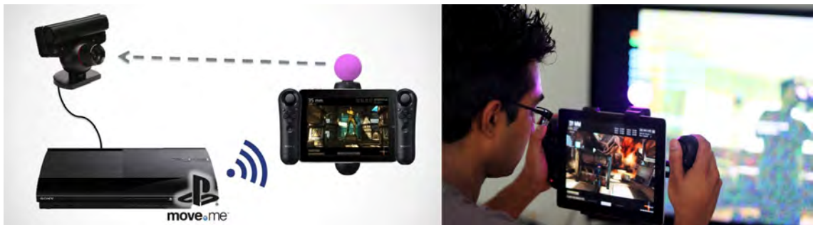
Abbildung 2.8: Das virtuelle Kamera-System SmartVCS , nutzt Playstation Hardware zur Realisierung eines präzisen Trackings im Weltkoordinatensystem. [BD13]
