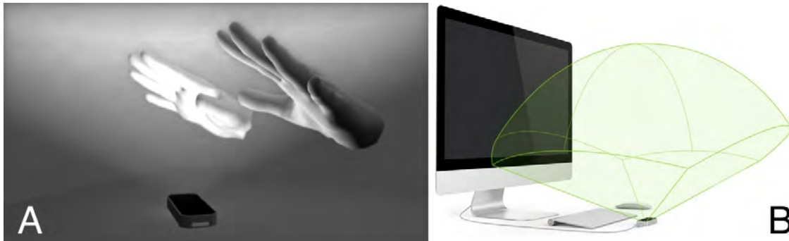
Abbildung 3.9: (A) Visualisierung der Sicht des Leap Motion-Kameras auf die Hände des Anwenders. (B) Sichtfeld-Visualisierung des Leap Motion-Controllers.
