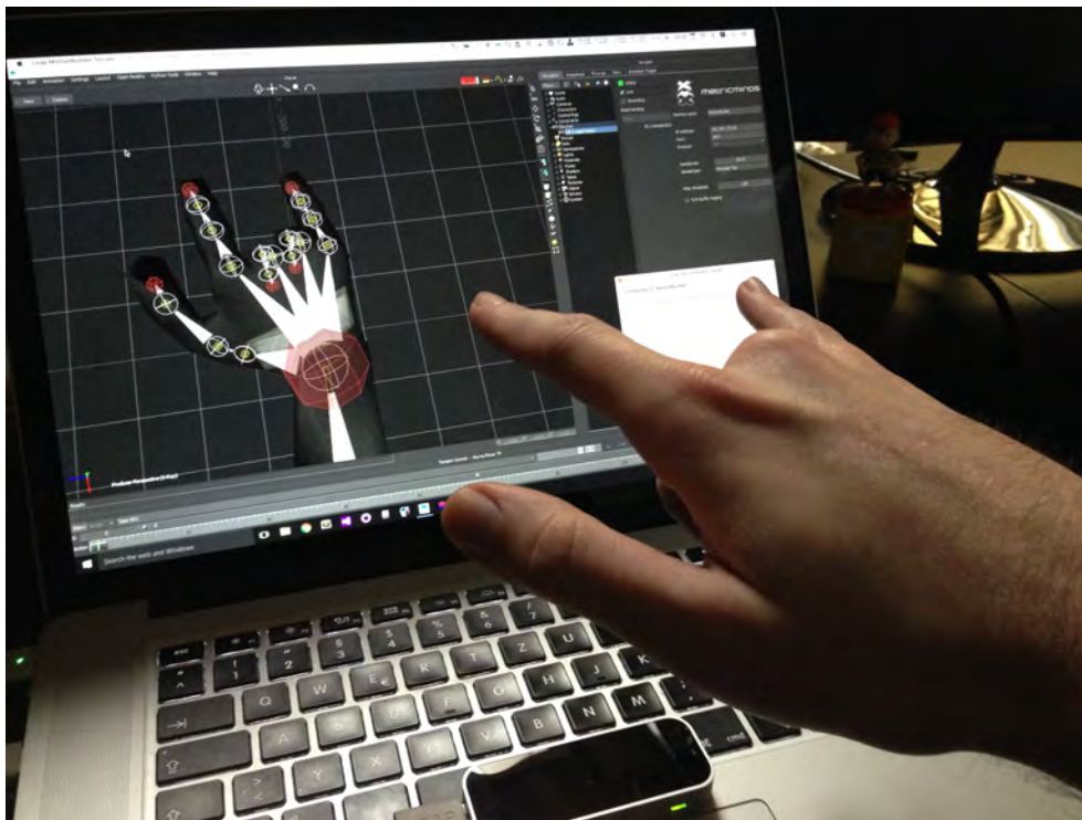
Abbildung 5.9: Die umgesetzte Integration des Leap Motion-Controller im Betrieb mit aktiver Übertragung der Tracking-Daten auf das Arago Hand-Rig.
