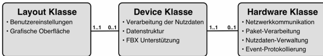
Abbildung 4.2: Vereinfachtes Klassendiagramm des MotionBuilder Plugins. Die zentrale Klasse ist das Device , welches über die Hardware -Klasse mit den Datenquellen kommuniziert. Die Oberfläche verwaltet die Layout -Klasse.
