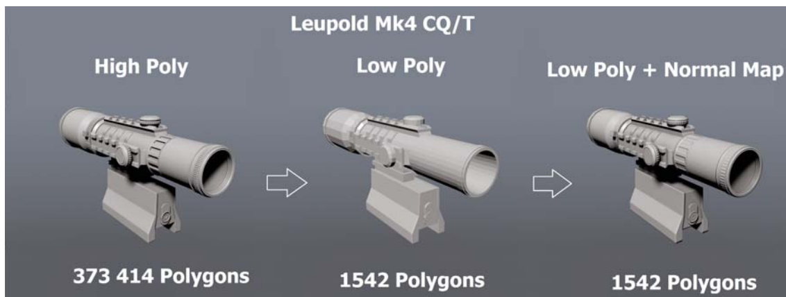
Abbildung 2.4: Mittels Baking werden auf ein Low-Poly Modell die Details des High-Poly Modells projiziert. 16
