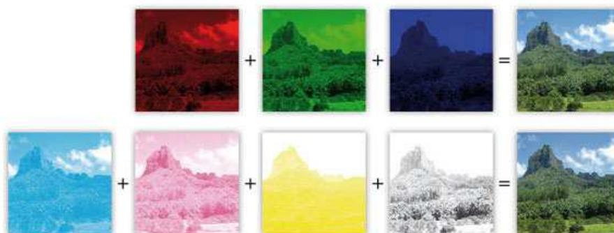
**Abbildung 3.9:** Zusammensetzung einzelner Kanäle von RGB und CMYK. Quelle: <http://bit.ly/RuvFt7>
