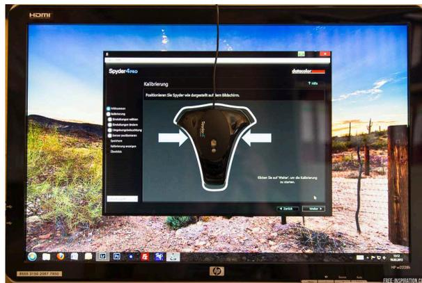
**Abbildung 4.2:** Einsatz des Kolorimeters Spyder4Pro von datacolor. Quelle: <http://bit.ly/1qMwTfR>
