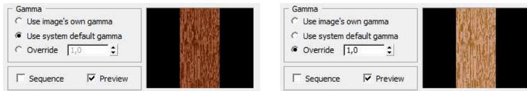
**Abbildung 4.9:** Texturen mit unterschiedlichem Gammawert laden. Links: Verwendet einen Wert von 2,2. Rechts: Verwendet einen Wert von 1,0
