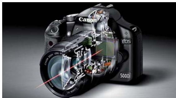
Abbildung 3.3: Das Licht fällt durch das Objektiv auf den Sensor | ©Kleine-Fotoschule.de 4
