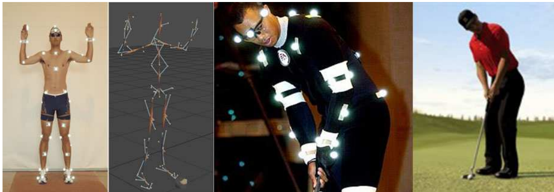
Abbildung 2.1: Die Abbildung zeigt die markerbasierte Erfassung von zwei Sportler. Hierbei werden die Bewegungen direkt am Coputer gespeichert.
