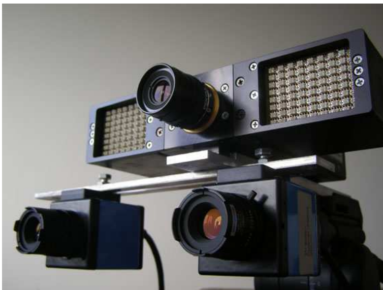
Abbildung 2.4: Die Abbildung zeigt eine mögliche Aufbauvariante eines Time-of-flight-Kamerasystems.
