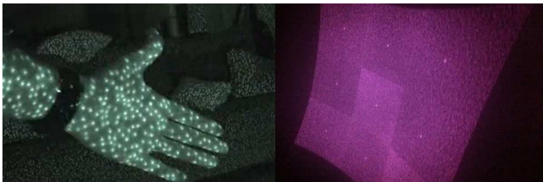
Abbildung 2.8: Die Abbildung zeigt das Infrarotgitternetz der Kinect. Foto(links): http://donaldclarkplanb.blogspot.de/2011/01/kinect-from-mr-kinect-himself.html Foto(rechts): http://123kinect.com/kinect-forums/Thread-Eye-trouble-from-Kinect-Laser
