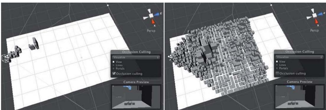
**Abbildung 4.5:** Vergleich in *Unity*; links: gerendete Szene mit *Occlusion Culling*, rechts: gerendete Szene ohne *Occlusion Culling*<sup>3</sup>
