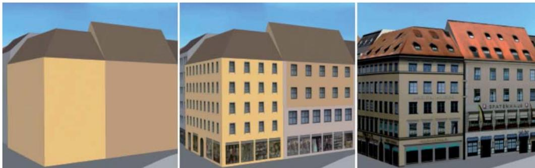
**Abbildung 2.10:** Automatisierte Modellierung und Texturierung anhand von Bilddaten mit *tridicon* [Lie08]. Links: anhand von Geo- und Bilddaten automatisch modellierte Gebäude, mitte: mittels Bilddaten ermittelte Fensterreihen, rechts: automatische Texturierung mit georeferenzierten Originalbildern<sup>17</sup>.
