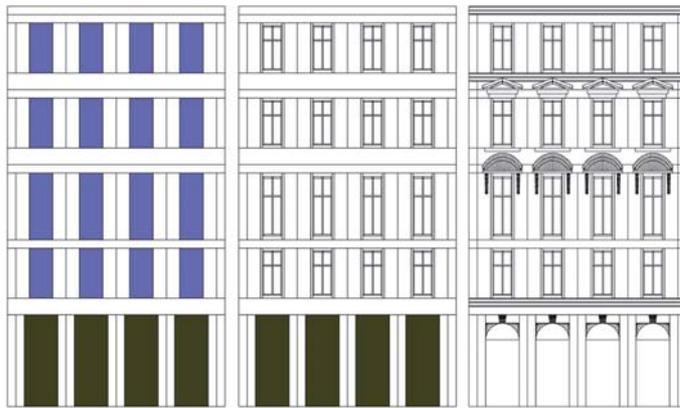
**Abbildung 2.6:** *CityEngine*-Fassade mit *Level of Detail*. V.l.n.r.: LOD0, LOD1, LOD2<sup>6</sup>.
