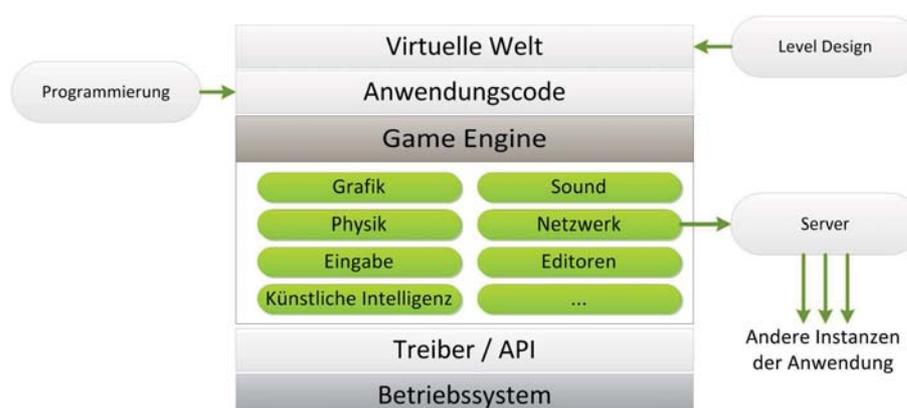
Abbildung 3.7: Schichtenmodell von 3D-Echtzeitanwendungen mit modularer *Game Engine*. Angelehnt an [LJ02].
