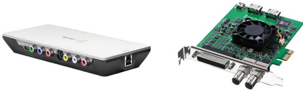
Abbildung 4.2: Durch eine interne oder externe Videokarte können Videosignale in den Computer eingespeist werden (Quelle: Blackmagic Design).
