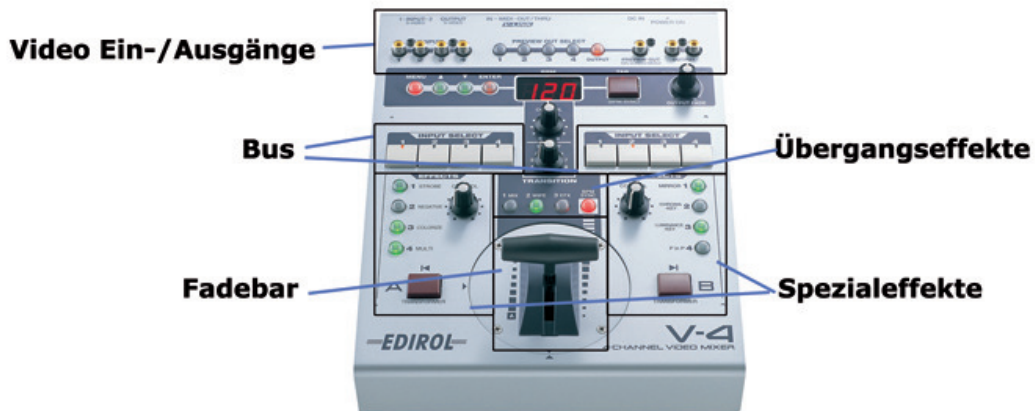
Abbildung 4.4: Die wichtigsten Elemente eines Videomischers (Quelle: Roland Corporation).
