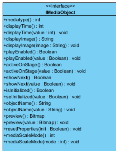
Abbildung 7.6: Die IMediaObject-Schnittstelle sorgt dafür, dass bei den verschiedenen Medienobjekten gleiches Verhalten implementiert wird.
