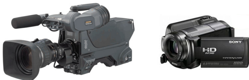
Abbildung 4.1: Bei Videokameras oder Camcordern wird das Videosignal live ausgegeben (Quelle: Sony Corporation).
