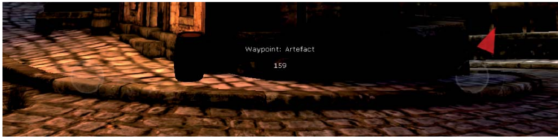
Abb. 4.12: Screenshot des Navigationssystems Version 0 - An der rechten Seite der Stick mit dem Zielpfeil, in der Mitte der Text mit dem Abstand zum Wegpunkt und dessen Name
