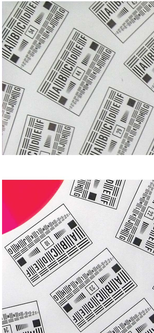
Abbildung 4.10: Vergleich von Bildschärfe und -details an den Bildrändern (oben) und im Zentrum (unten). Die beiden 100%-Ansichten zeigen deutlich die Abnahme von Auflösung und Schärfe in den Randbereichen der Aufnahme. Dieses Phänomen betrifft sämtliche optische Systeme, tritt aber vor allem bei geringwertigeren Objektiven stärker in Erscheinung. (Quelle: Ausschnitt aus Abbildung 4.12, Ergebnis-HDRI im „Querformat nebeneinander parallel“.)
