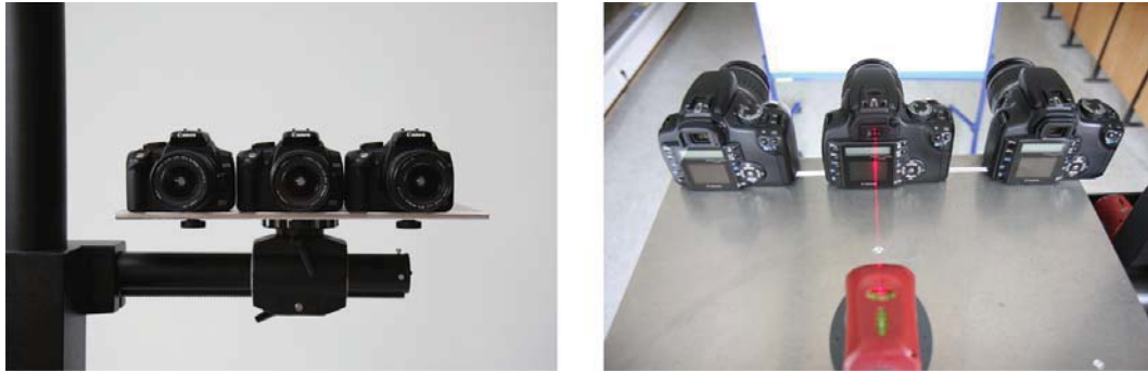
Abbildung 3.9: Aufbau und Ausrichtung der Kameras im Querformat nebeneinander.
