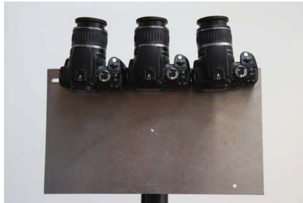
Abbildung 2.14: Eigens angefertigte Metallplatte mit Schiene zur Befestigung von drei Kameras.
