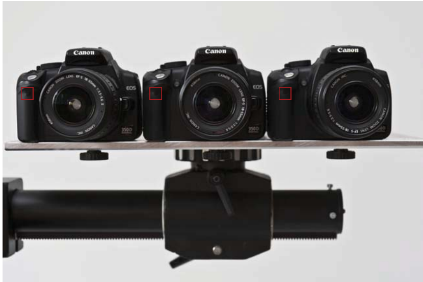
Abbildung 3.11: Infrarot-Empfänger auf der Vorderseite der Canon EOS 350D (siehe rote Kästchen).
