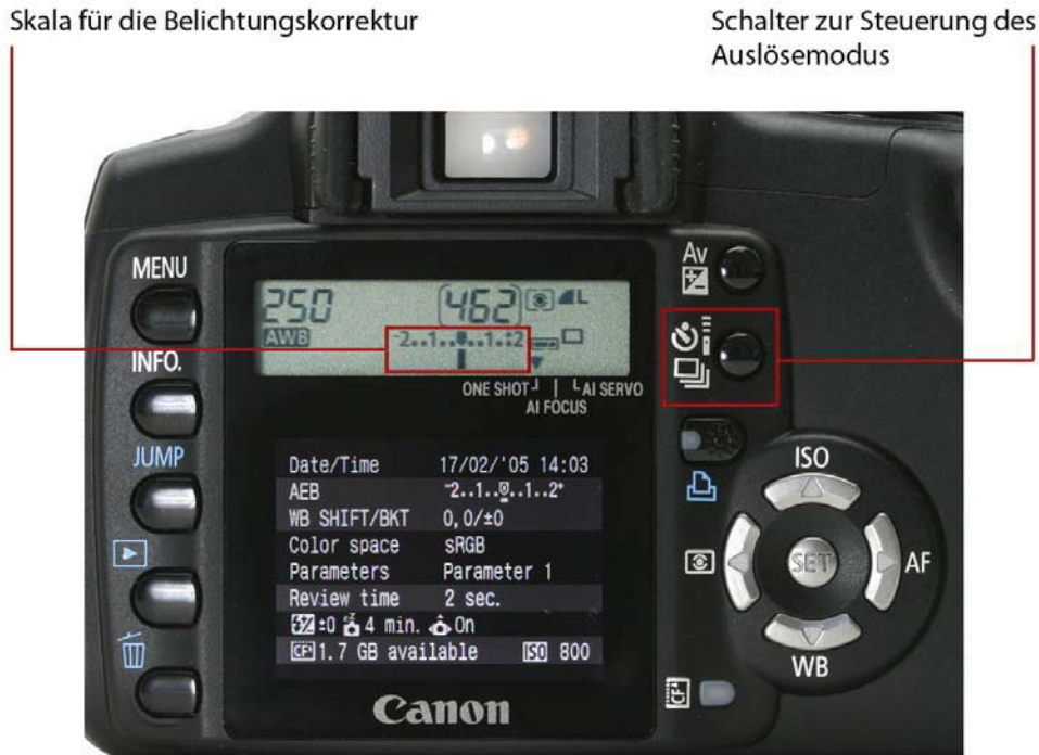
Abbildung 3.10: Display der Canon EOS 350D auf der Kamerarückseite mit Belichtungsskala und Schalter zu Wahl des Auslösemodus. (Quelle: Digital Photography Review 40 , 2005, verändert.)
