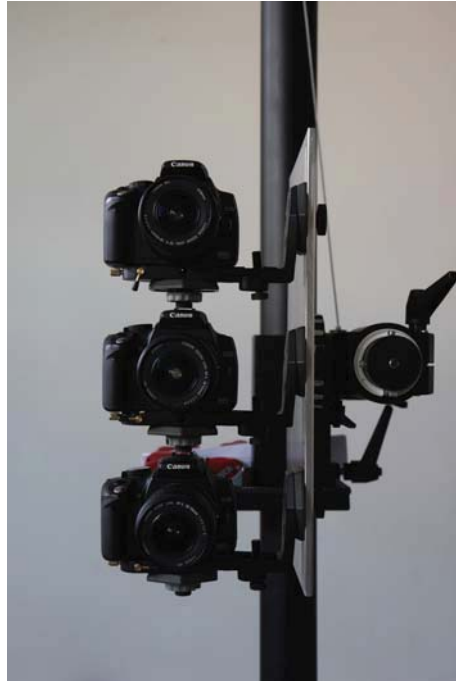
Abbildung 3.8: Ausrichtung der Kameras im Querformat untereinander.
