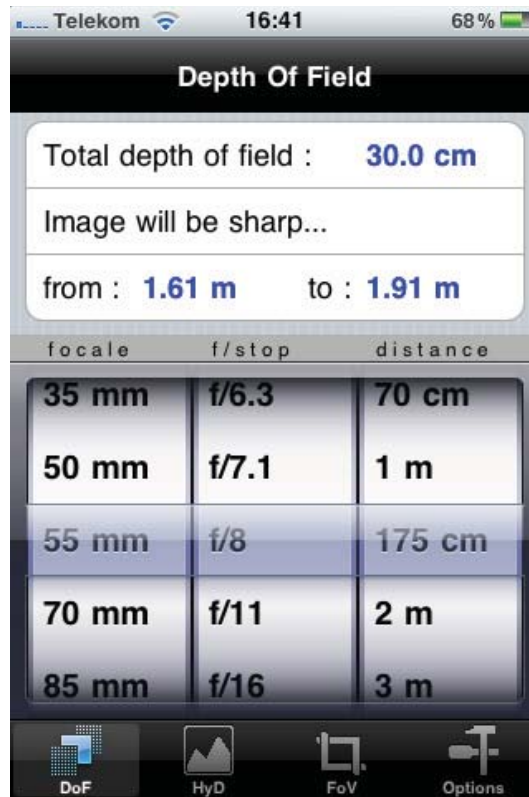
Abbildung 3.15: Oberfläche der iPhone-App „DoF Plus“ mit Schärfentiefe-rechner.
