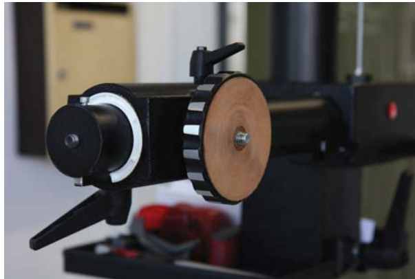
Abbildung 2.17: Kamerakopf Manfrotto 826 am Horizontalarm des MINI SALON 230.
