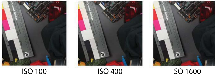
Abbildung 2.6: Zunehmendes Bildrauschen bei höheren ISO-Werten. Drei Bildausschnitte der gleichen Testszene bei ISO 100, 400 und 1600. (Kamera: Canon EOS 40D, Quelle: heise Foto 17 , 2008, verändert.)
