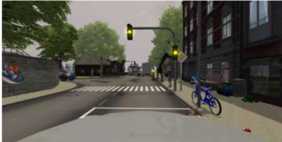
Abbildung 2.3: Einzelbild einer Computergrafik-Simulation für funktionale kamerabasierte Steuergerätestests (Quelle: MBtech Group).
