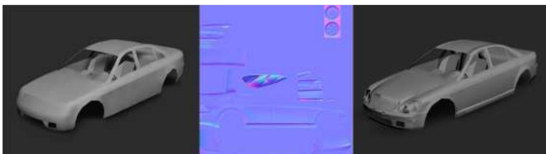
Abbildung 4.4: Das Fahrzeug (links) kann durch Zuweisen der Normalmap (mitte) im Detailreichtum deutlich erhöht werden (rechts).
