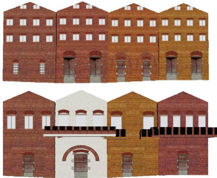
**Abbildung 6.3:** Fehler bei der LOD Modellerstellung. Oben: eine Hausreihe von LOD0 Modellen. Unten: die LOD1 Modelle der selben Hausreihe.
