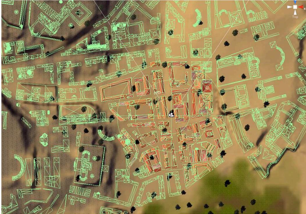
**Abbildung 5.10:** Die Vogelperspektive auf die Szene zur Laufzeit der Anwendung. Im Bereich der Sphären werden die passenden LOD Modelle geladen und angezeigt. Modelle außerhalb der Sphären werden weder angezeigt noch sind sie geladen.
