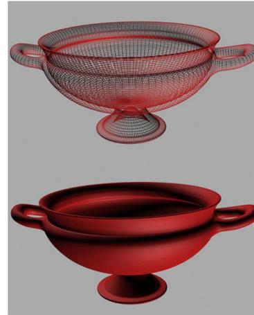
Abbildung 2.16: Drahtgitter- und Flächenmodellldarstellung eines Keramikgefäßes [pVHFr] (geändert)
