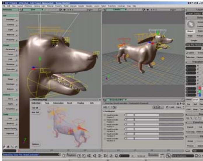
**Abb. 7.1:** Eine, für die Arbeit mit dem Rig sinnvolle, Anordnung: User-Camera, Standard-Kamera, Property-Editor und Synoptic View
