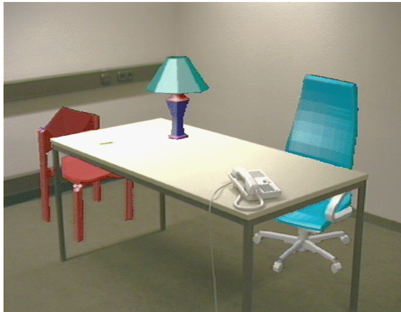
Abbildung 3.3: Ein realer Tisch verdeckt zwei virtuelle Stühle unter Verwendung der Modellbasierten Methode [Bree95]
