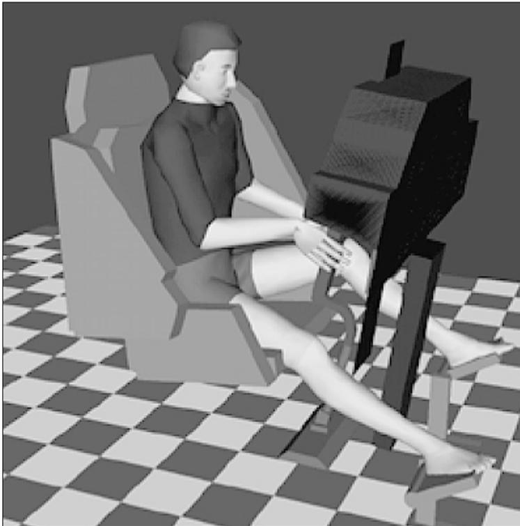
Abbildung 2.3: Jack als High-Resolution-Modell in einer Apache-Hubschrauber-Simulation [1]
