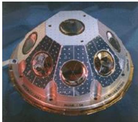
Abbildung 3.7: Retroreflektor von ERS 1+2 [ILR03]
