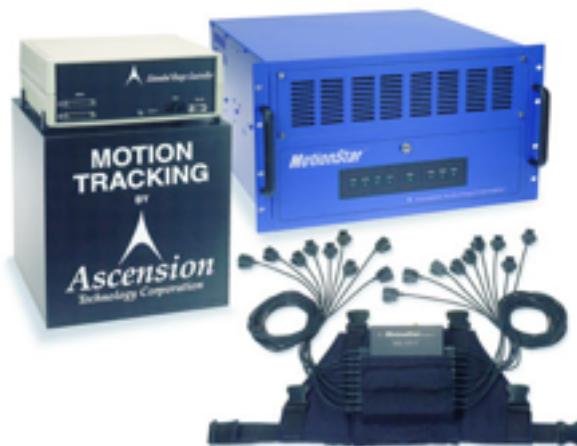
Abbildung D.2.: Ascensions Motion Star Wireless: Das Bild zeigt den Magnetfeldgenerator (links), die Steuereinheit (hinten rechts) sowie die Sensoren samt Funkeinrichtung (aus [Asc04b])
