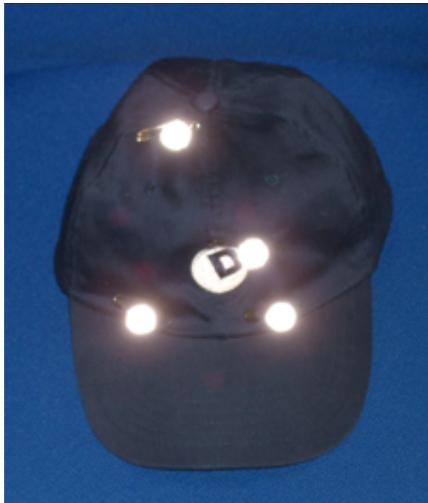
Abbildung 5.2.: Schildkappe zur Erfassung von Position und Orientierung des Kopfes
