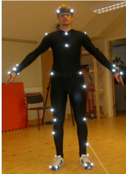
Abbildung 3.8.: Akteur mit einem markerbestückten Motion Capturing-Anzug (aus [Tei03])
