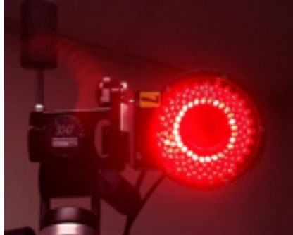
Abbildung 3.10.: Kamera mit leuchtendem LED-Kranz (aus [Uni04])
