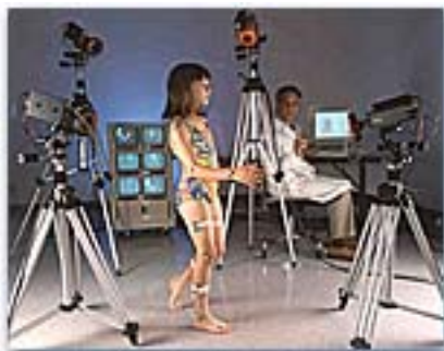
Abbildung 2.1.: Ganganalyse mittels Motion Capturing (aus [Mot04d])
