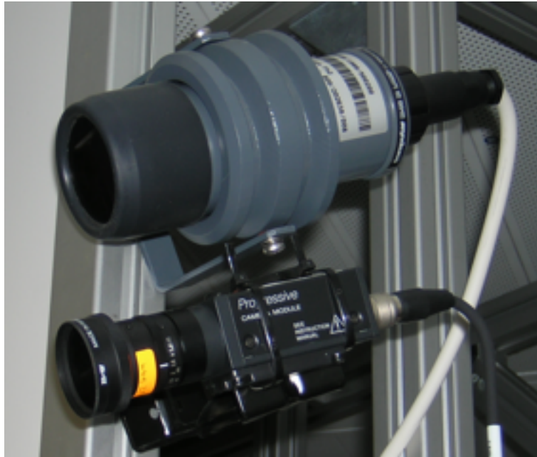
Abbildung A.1.: EOS: Anordnung Kamera und IR-Spot
