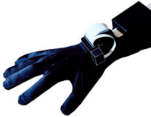
Abbildung 3.1.: Datenhandschuh als Beispiel für ein Inside-In Tracking-System (aus [Fif02])
