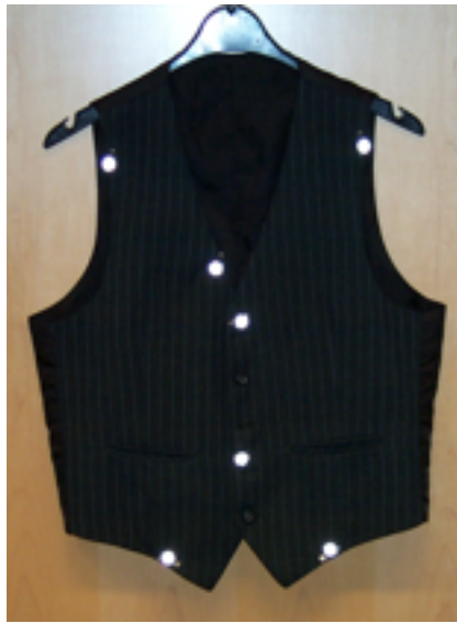
Abbildung 5.3.: Weste zur Erfassung von der Körperbewegung
