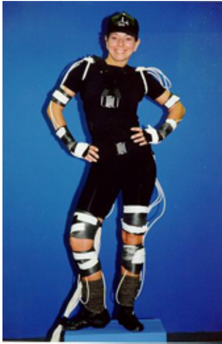
Abbildung 3.6.: Akteur mit magnetischem kabelgebundenen Tracking-System (aus [Bod02])
