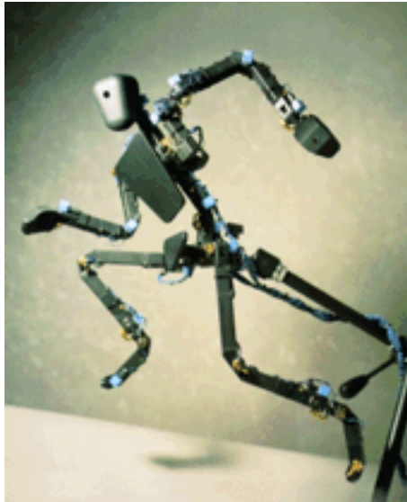
Abbildung 3.5.: Mechanische Armatur in menschenähnlicher Gestalt (aus [Dig04a])
