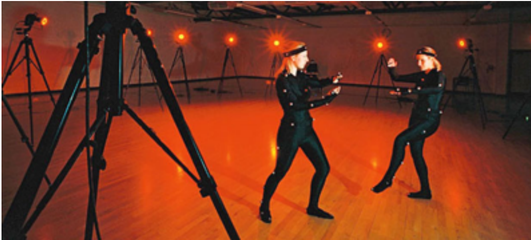
Abbildung 3.11.: Passives optisches Motion Capturing-System: Um den Aktionsbereich sind Kombinationen von Kamera-Strahlern aufgestellt, die beiden Akteure tragen reflektierende Marker (aus [Tei03])
