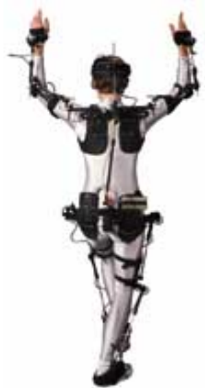
Abbildung 3.4.: Akteur mit mechanischem Exoskelett in gestreckter Pose (aus [Met04b])
