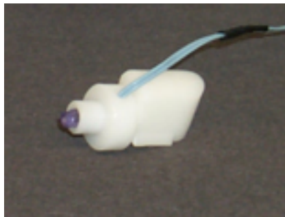
Abbildung A.4.: Aktiver Infrarot-Marker
