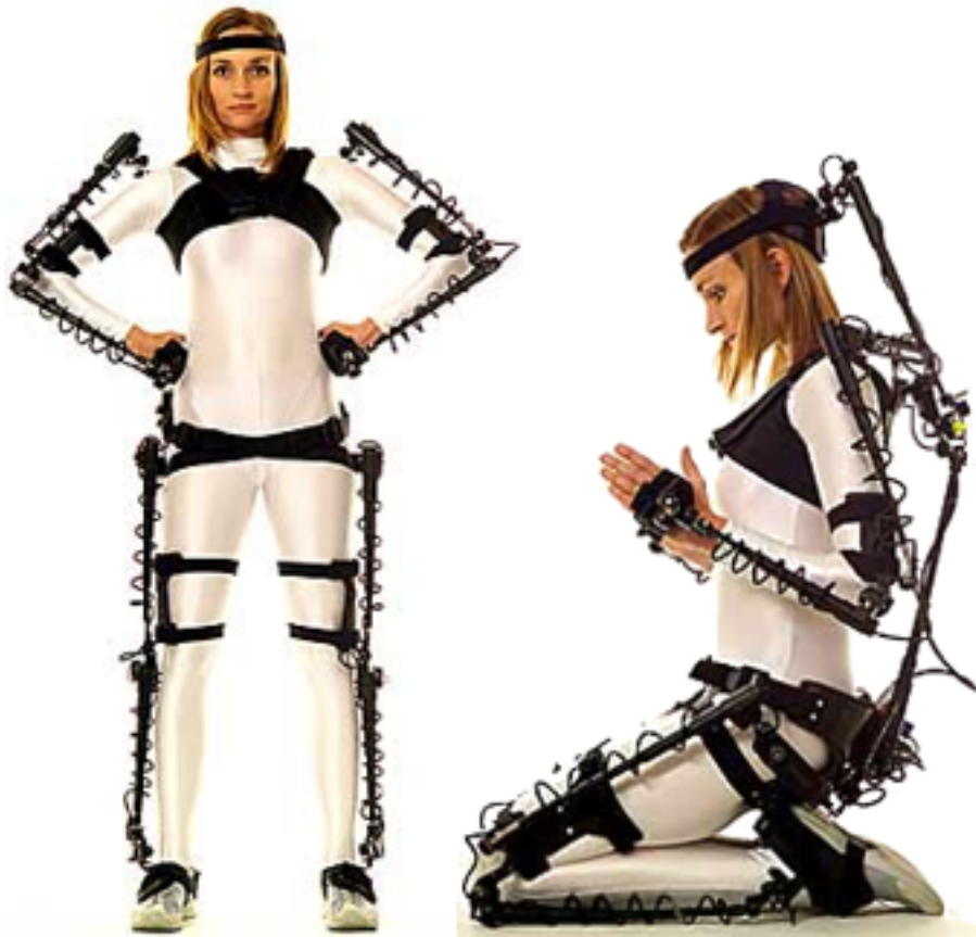
Abbildung D.4.: Gypsy 4 Motion Capturing System: Akteur im Exoskelett (aus [Met04a])
