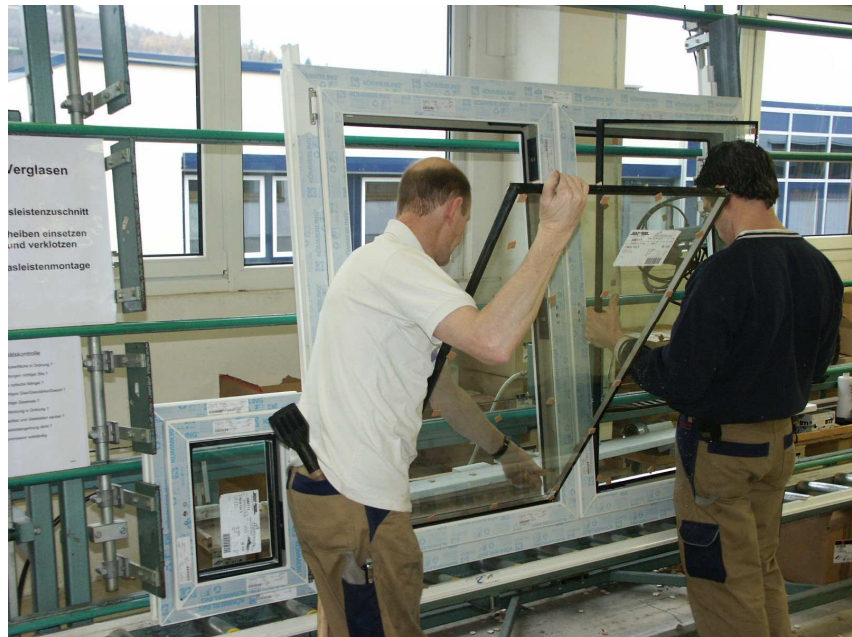
Abbildung 15: Verglasen der Fenster
