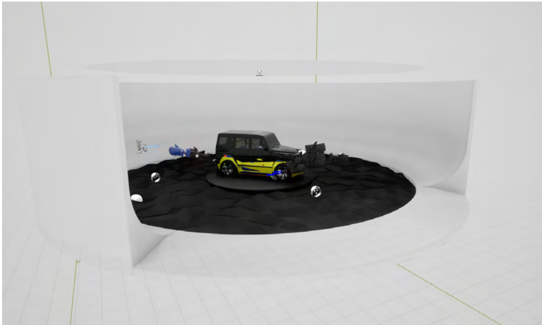
Abbildung 4.7: Das Studio-Level im Unreal Editor. Zu sehen sind neben dem Auto-Modell mit Kamerapositionen und den Meshes des Levels, oben eine VRayLightRect und zwei von fünf SphereReflectionCaptures über dem Boden im Vordergrund.
