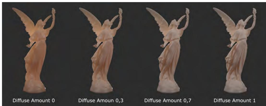
**Abbildung 3.39:** Visualisierung, wie sich das Rendering verändert, wenn über eine Steigerung des *Diffuse Amounts* das Mischungsverhältnis von diffusem und *Subsurface Scattering*-Anteil geändert wird.
