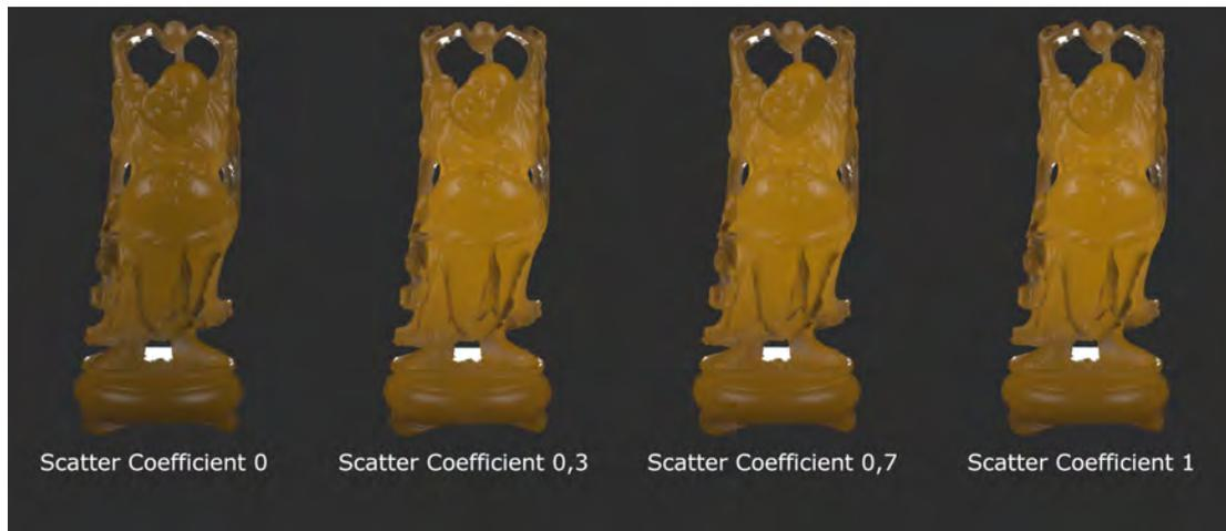
**Abbildung 3.9:** Die Auswirkungen des *Scatter coefficient* auf das Material.
