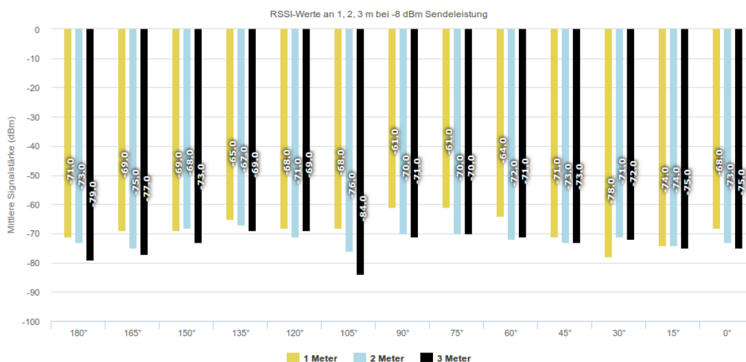
Abbildung 6.9: Winkelabhängige Messungen bei frontaler Ausrichtung und einer Sendeleistung von -8 dBm.
