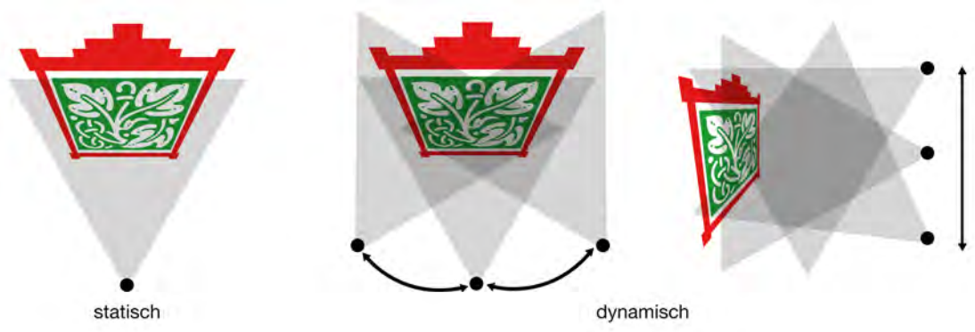
Abbildung 6.8: Das Anlernen und Erkennen erfolgt durch statische und dynamische Positionierung, wobei mit statisch eine feste Position mit optimaler Ausrichtung auf das Exponat / Objekt gemeint ist. Bei dynamischem Anlernen oder Erkennen wird das Objekt aus mehreren sinnvollen Perspektiven angelernt und erkannt.
