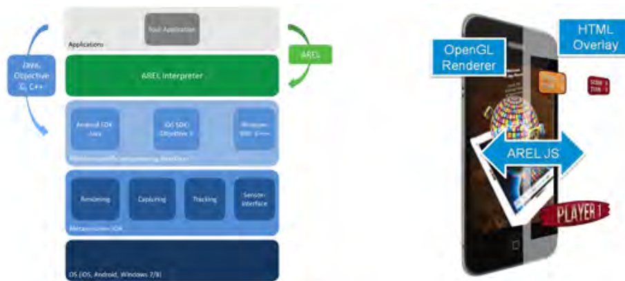
Abbildung 2.6: Die Abbildung links zeigt, wie der Arel Interpreter bei Metaio in das System interferiert wird. Abbildung rechts zeigt das Prinzip des Overlays bei Arel Anwendungen ( http://dev.metaio.com/arel/overview/ Stand: 12. Januar 2015).
