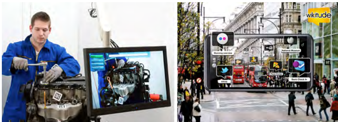
Abbildung 2.4: Links ein Anwendungsbeispiel für den Bereich Maschinenbau / Industrie. Anhand von 2D-Barcodes, die an den Einzelteilen der zu reparierenden Maschine angebracht sind, ermittelt das System Kameraposition und -richtung und sendet diese Daten an den Experten. © Fraunhofer FKIE (links, http://goo.gl/gyfhCI Stand: 11. Januar 2015). Rechts ein Beispiel für den Bereich Shopping / Tourismus. Die Wikitude App zeigt dem Benutzer mit Hilfe von GPS und Orientierungssensor passend zu der Position und Ausrichtung des Gerätes Billboards. Diese können für die Positionen vorhandener Geschäfte und Lokale oder andere Informationen stehen (rechts, http://goo.gl/b3NaLz Stand: 11, Januar 2015).
