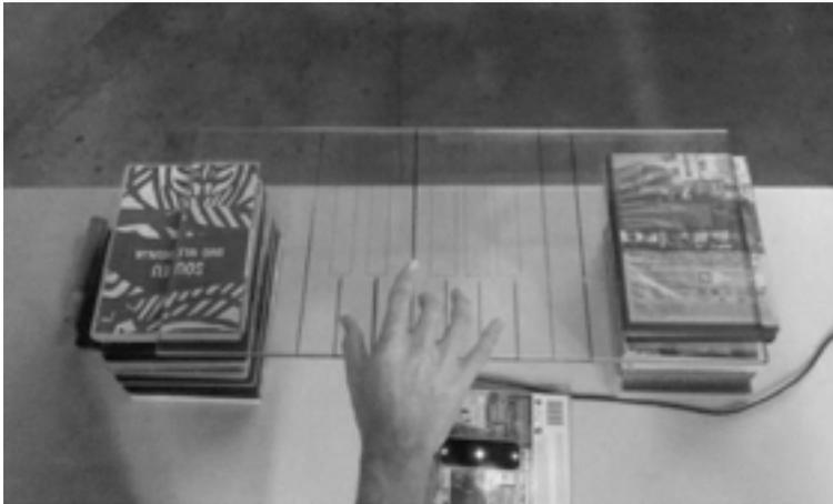
Abbildung 2.1: Glasscheibe mit aufgemalten Tasten über dem Leap Motion Controller [SdAdA<sup>+</sup>13]
