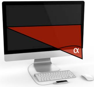
**Abbildung 5.14:** Der Winkel des horizontalen Sichtfelds ist abhängig von der Bildschirmbreite und dem Abstand zum Computerbildschirm.
