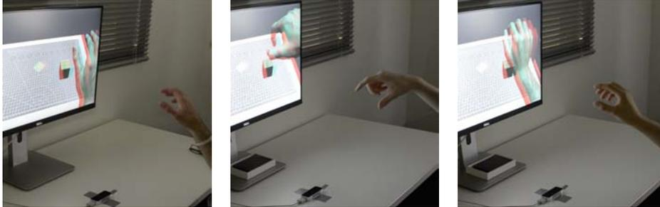
**Abbildung 7.5:** Eintrittsposition oberhalb des Interaktionsobjekts – Der überwiegende Teil der Probanden griff intuitiv von oben in das Interaktionsvolumen des Leap Motion Controllers. Die Gefahr, das Interaktionsobjekt hierbei unabsichtlich zu verschieben ist geringer als beim frontalen Eintritt in das Interaktionsvolumen.
