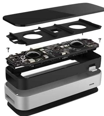
Abbildung 4.1: Explosionsgrafik des Leap Motion Controllers [Col14]
