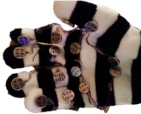
Abbildung 2.2: Haptischer Handschuh mit Vibrationsmotoren [Ngu14]
