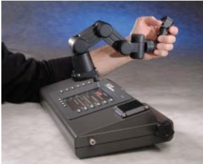
Abbildung 1.7: Kraft TeleRobotics mini-master Kontrollpult mit Krafrückkopplung [Kra14]
