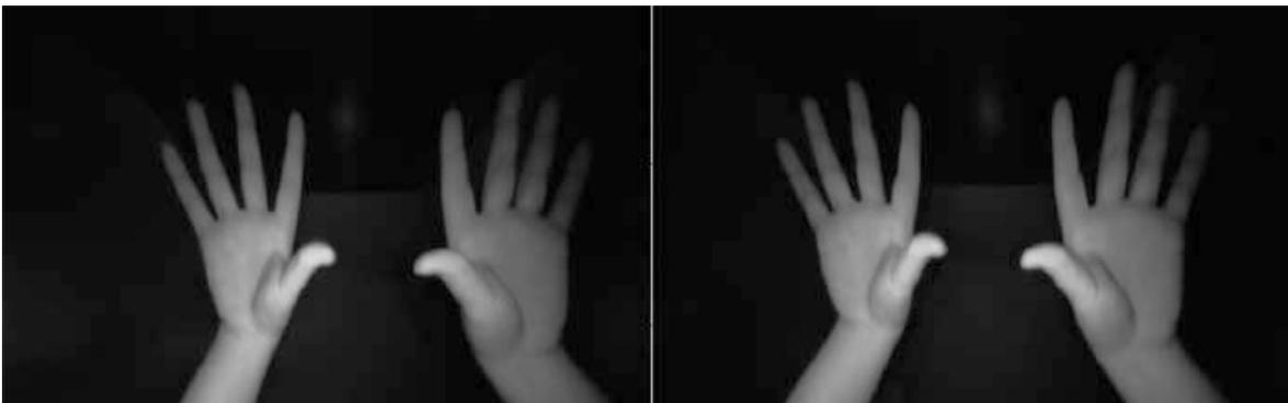
**Abbildung 4.2:** Rohdaten des Leap Motion Controllers – Das Bildpaar besteht aus dem linken Kamerabild (links) und dem rechten Kamerabild (rechts). Die Bilder weisen einen horizontalen Versatz zueinander auf, dessen Ausprägung von der Distanz zur Kamera abhängig ist.
