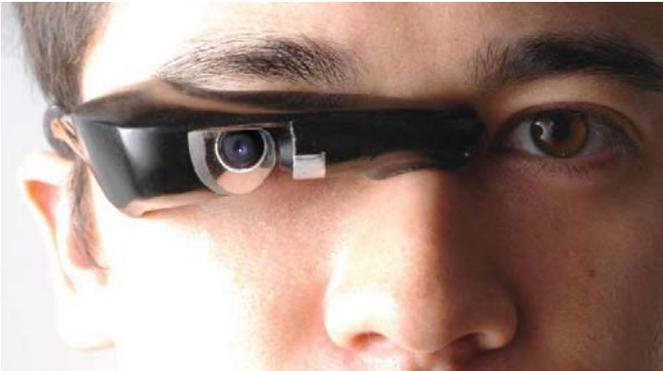
Abb. 5: Head-Mounted Display „EyeTab“
