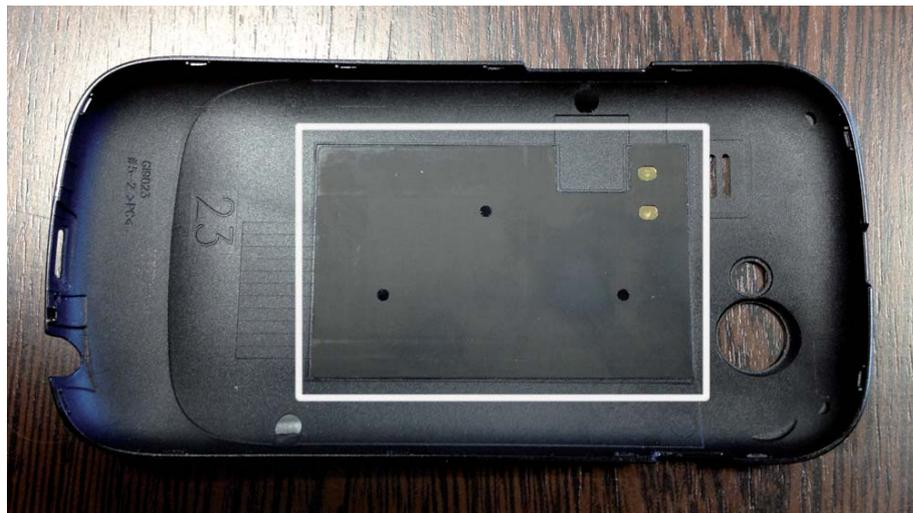
**Abbildung 1.2:** Samsung Nexus S-Deckel mit NFC-Antenne
