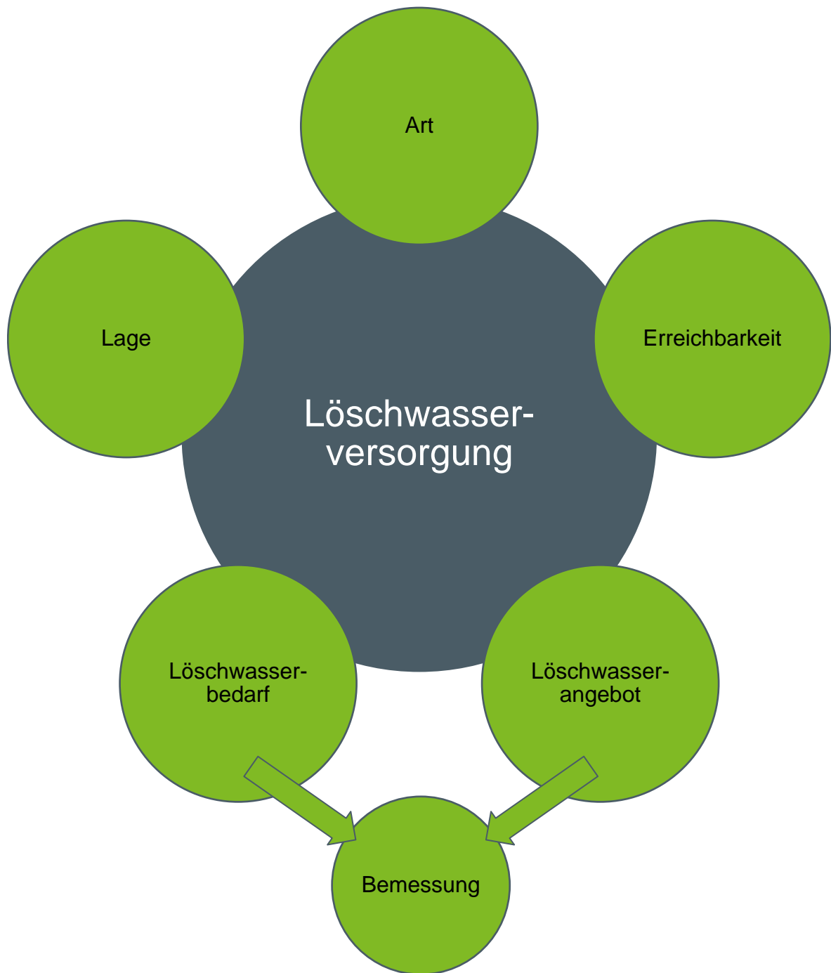
Abbildung 1: Aspekte der Löschwasserversorgung
