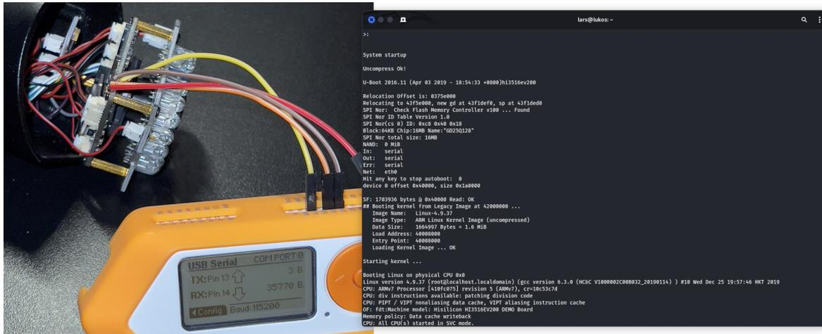
Abbildung 5.3: Auslesen von Systeminformationen einer IP-Kamera mittels USB zu UART Verbindung (Eigene Darstellung)
