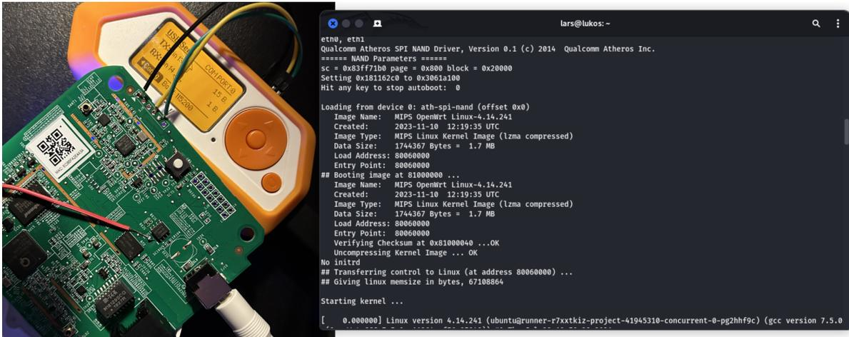
Abbildung 5.2: Auslesen von Systeminformationen einer Philips Hue Bridge mittels USB- zu UART-Verbindung (Eigene Darstellung)
