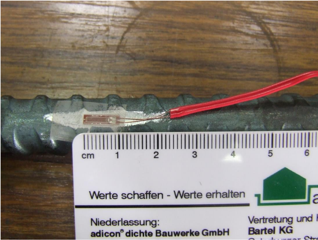
Dehnungs-Mess-Streifen auf der Bewehrung
