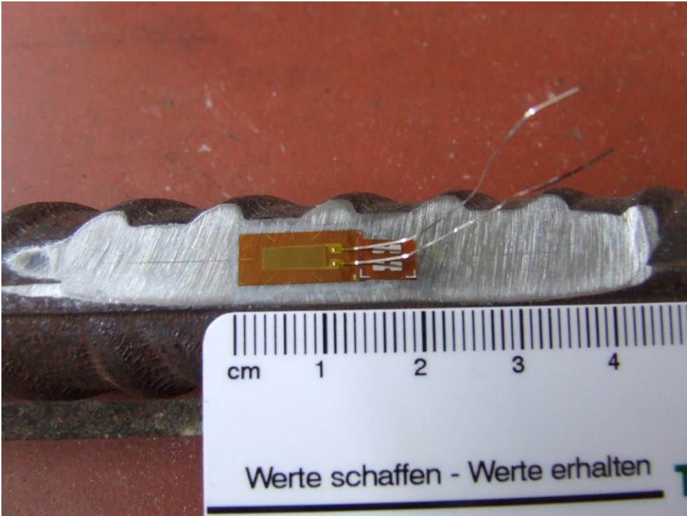
Dehnungs-Mess-Streifen auf der Bewehrung
