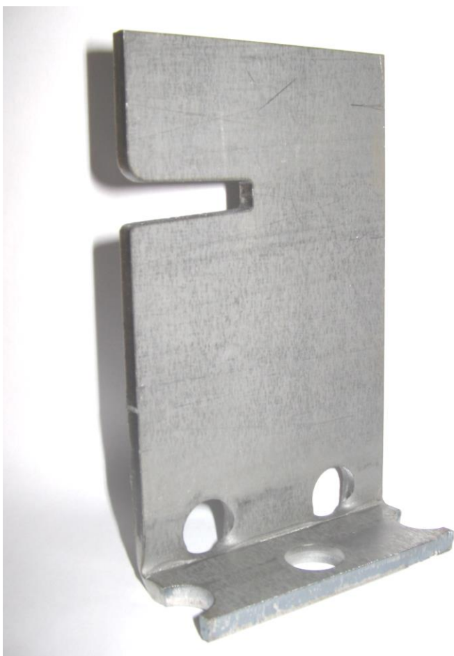
Bild 1: Einbauteil – einfach abgekantet – Versuchskörper EA und EB
