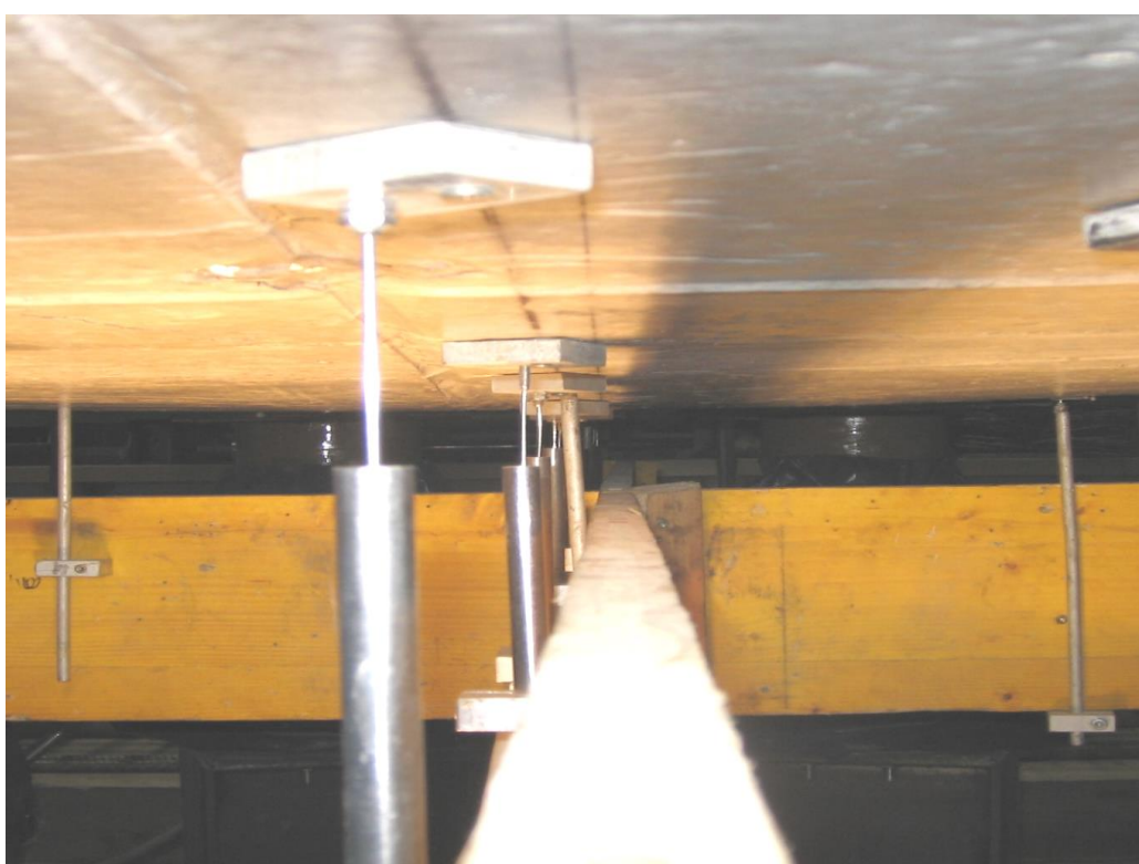
Bild 42: Wegaufnehmer während der Prüfung der Versuchskörper
