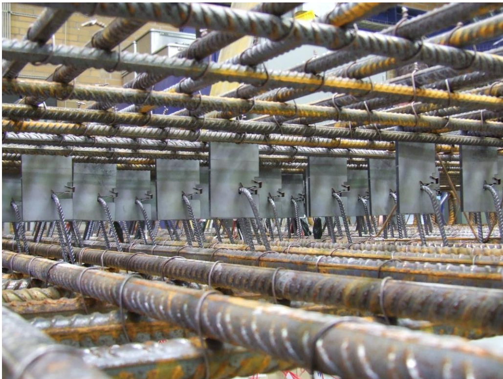
Bild 23: Lage der Einbauteile – Versuchskörper FD
