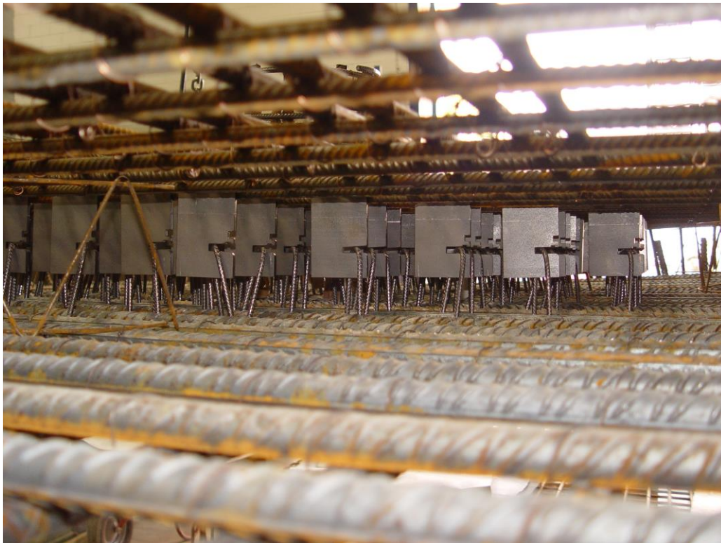
Bild 18: Lage der Einbauteile – Versuchskörper EH
