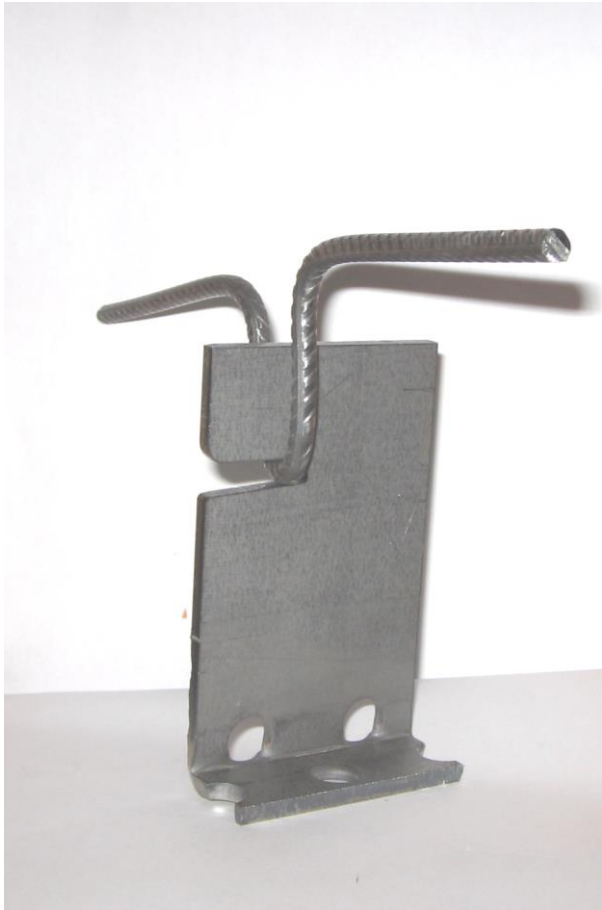
Bild 3: Einbauteil mit Haken verbunden – Versuchskörper EA und EB
