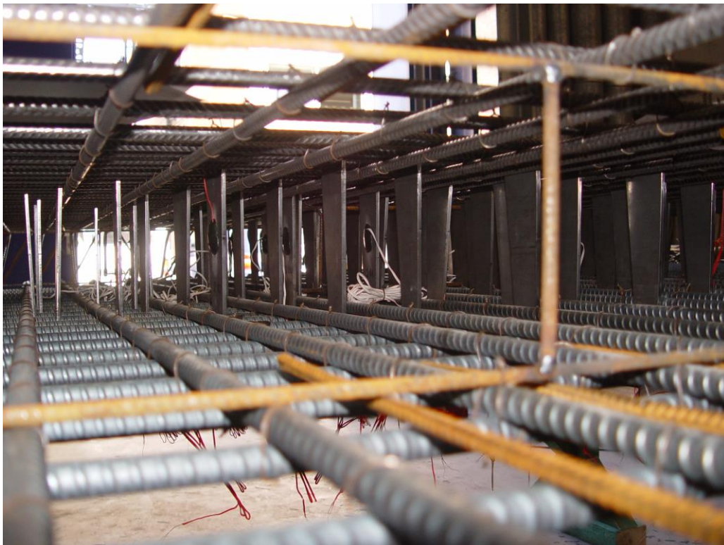
Bild 27: Lage der Einbauteile – Versuchskörper FF
