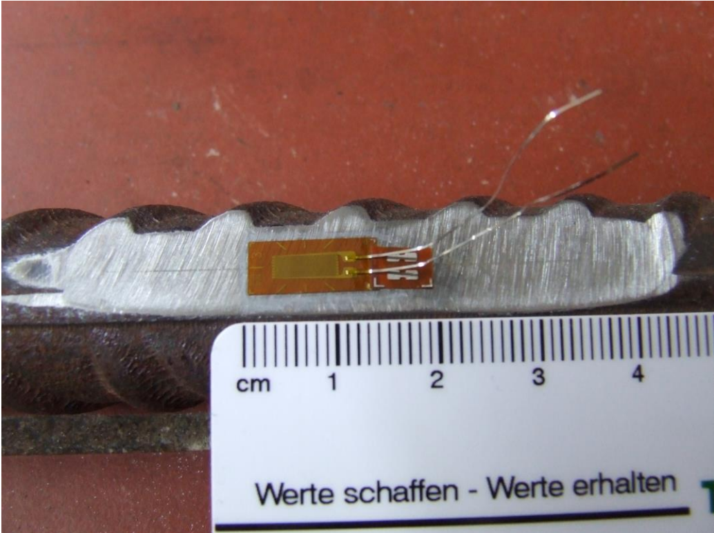
Bild 34: DMS für Längsbewehrung
