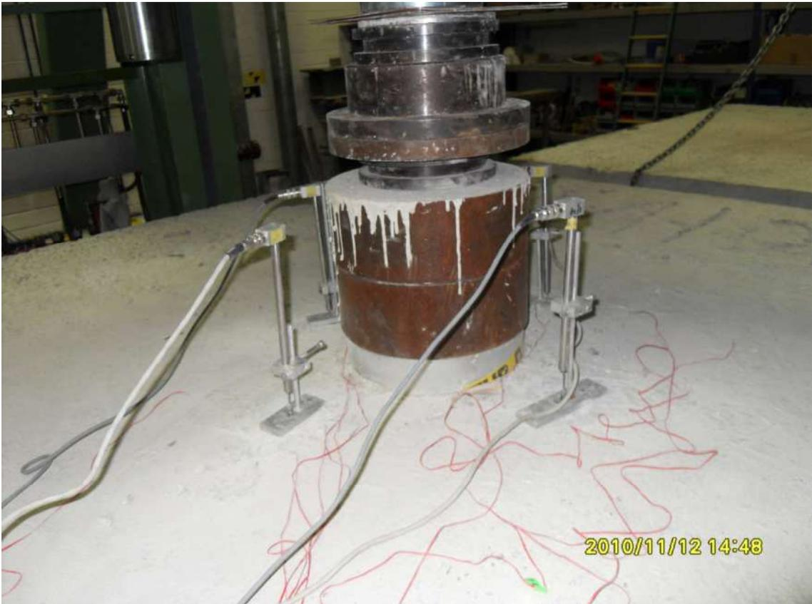
Wegaufnehmer - Messungen Versuchskörper LC
