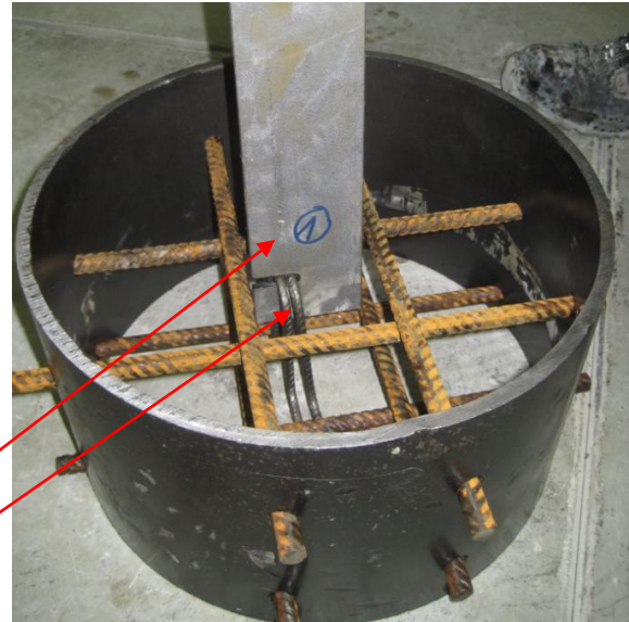
Abb. 1: Prüfkörper Bewehrungsbild L1 – L12
