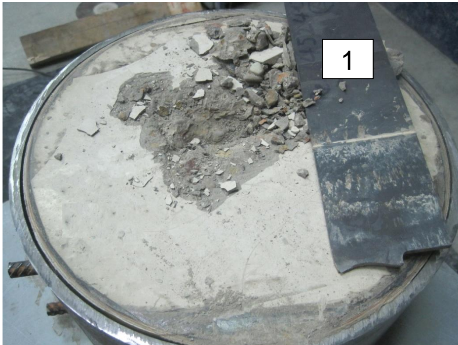
Prüfkörper L1 nach dem Versagen
