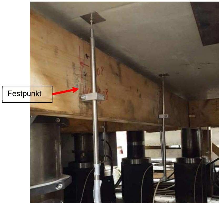
Wegaufnehmer im eingebauten Zustand
