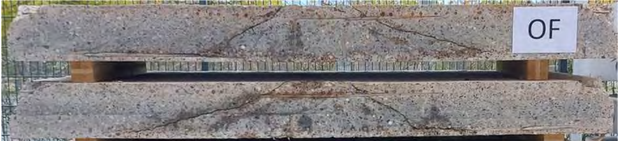
Rissverlauf im Schnitt
