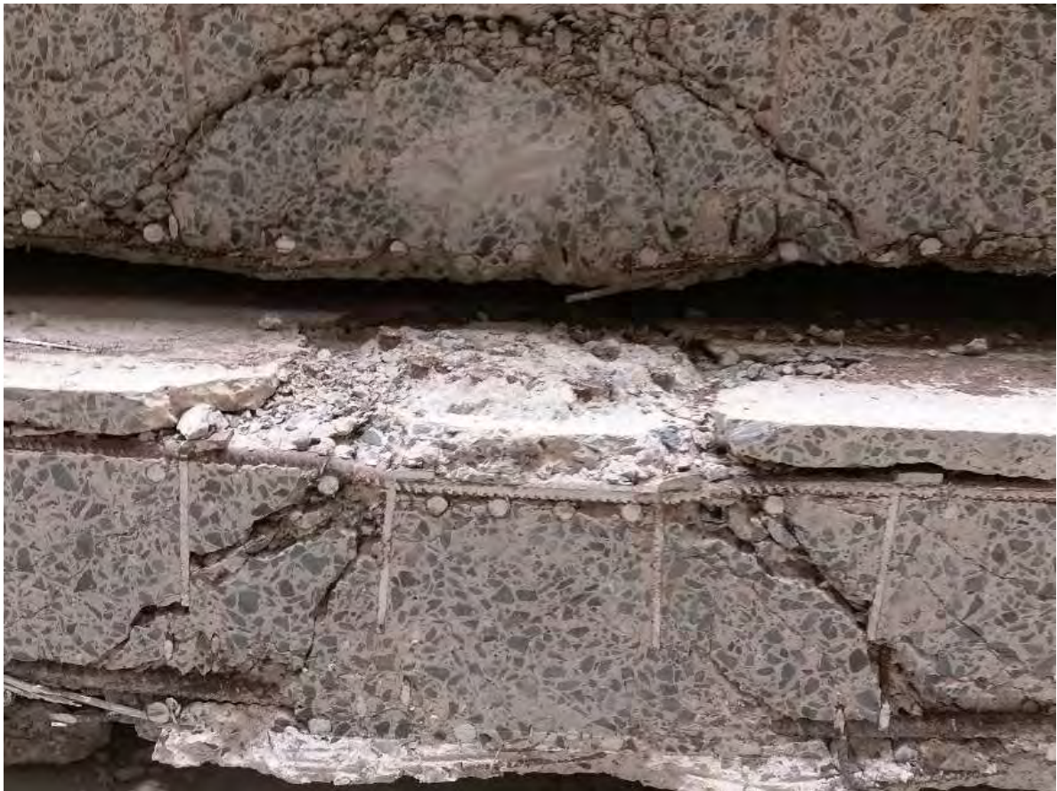
Rissverlauf im Schnitt
