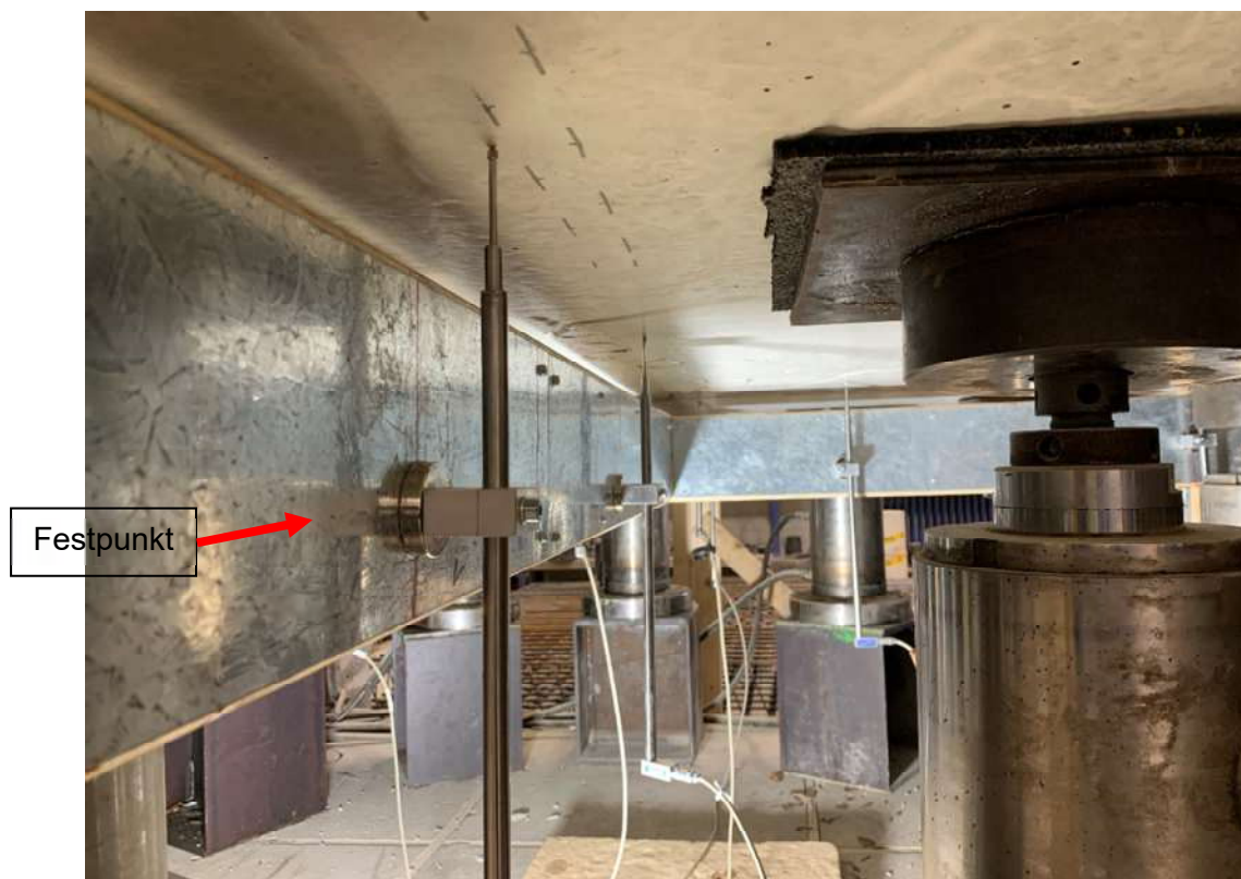
Wegaufnehmer im eingebauten Zustand
