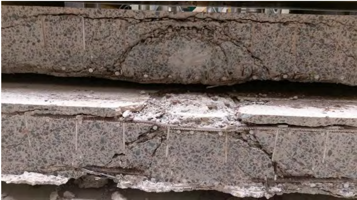
Rissverlauf im Schnitt
