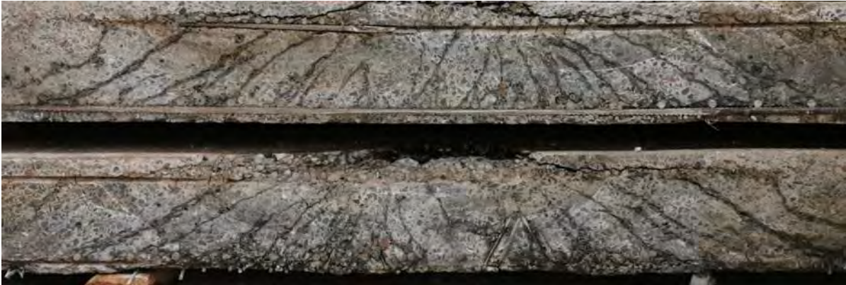
Rissverlauf im Schnitt
