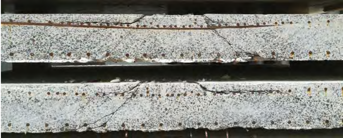
Rissverlauf im Schnitt
