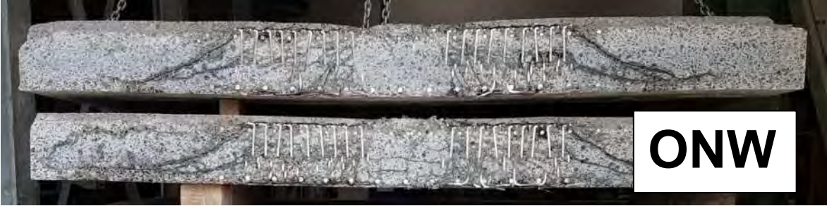
Rissverlauf im Schnitt
