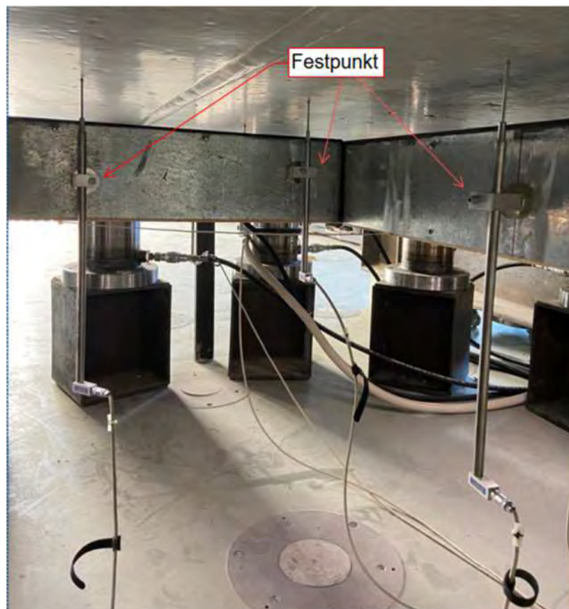
Wegaufnehmer im eingebauten Zustand
