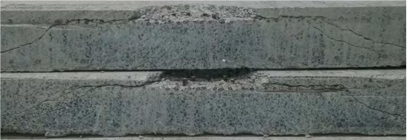
Rissverlauf im Schnitt
