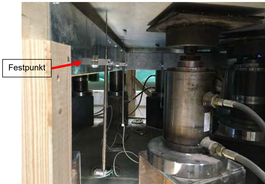
Wegaufnehmer im eingebauten Zustand
