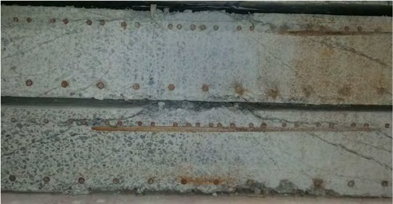
Rissverlauf im Schnitt
