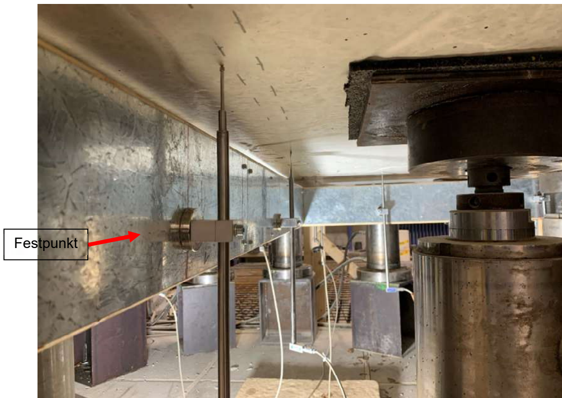
Wegaufnehmer im eingebauten Zustand
