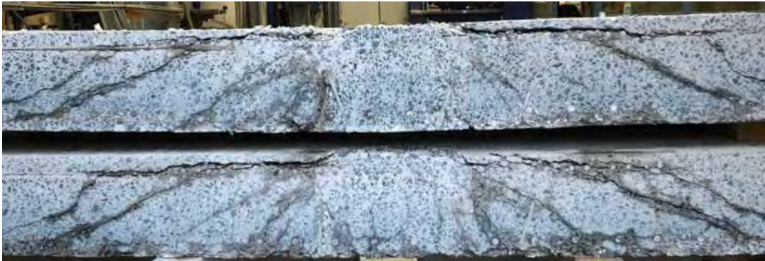
Rissverlauf im Schnitt
