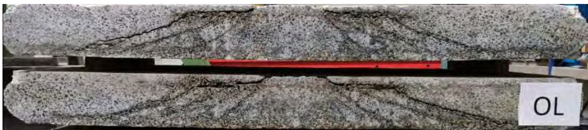
Rissverlauf im Schnitt
