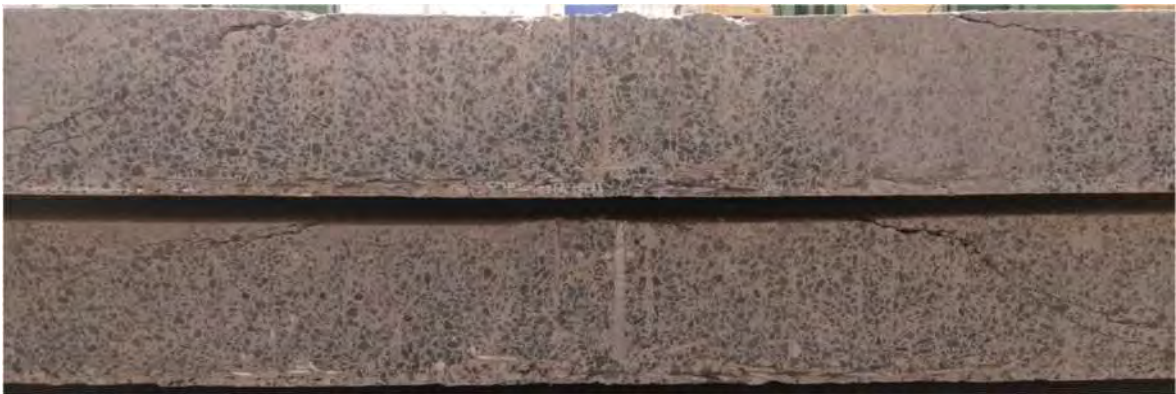
Rissverlauf im Schnitt
