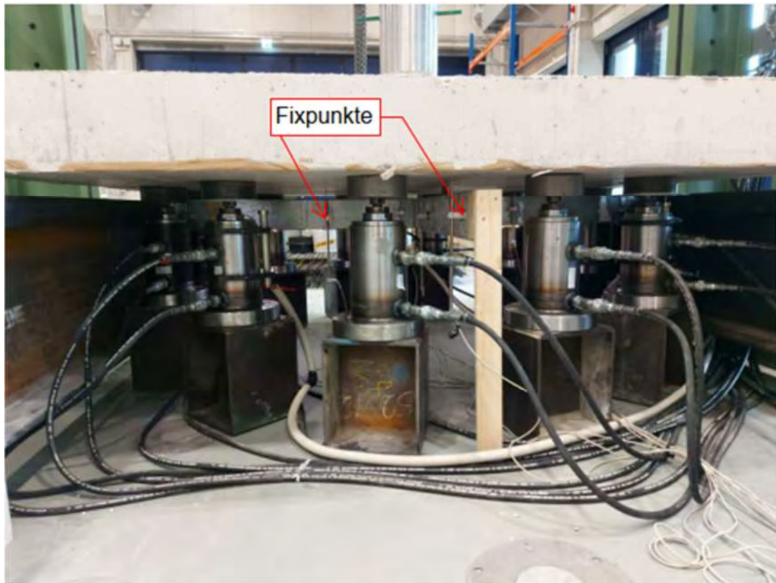
Wegaufnehmer im eingebauten Zustand
