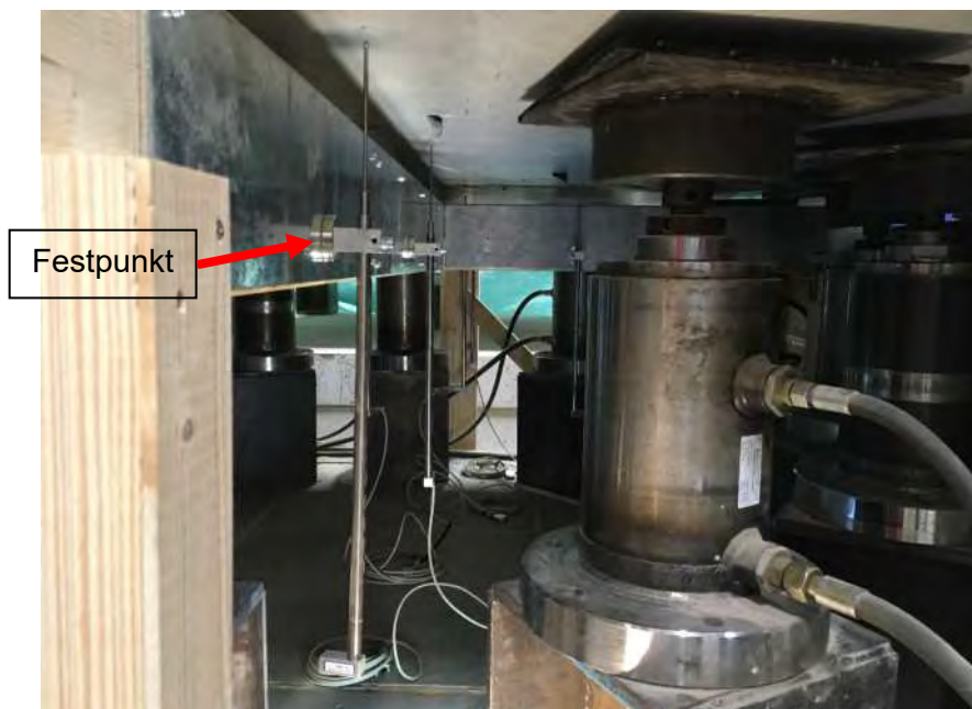
Wegaufnehmer im eingebauten Zustand
