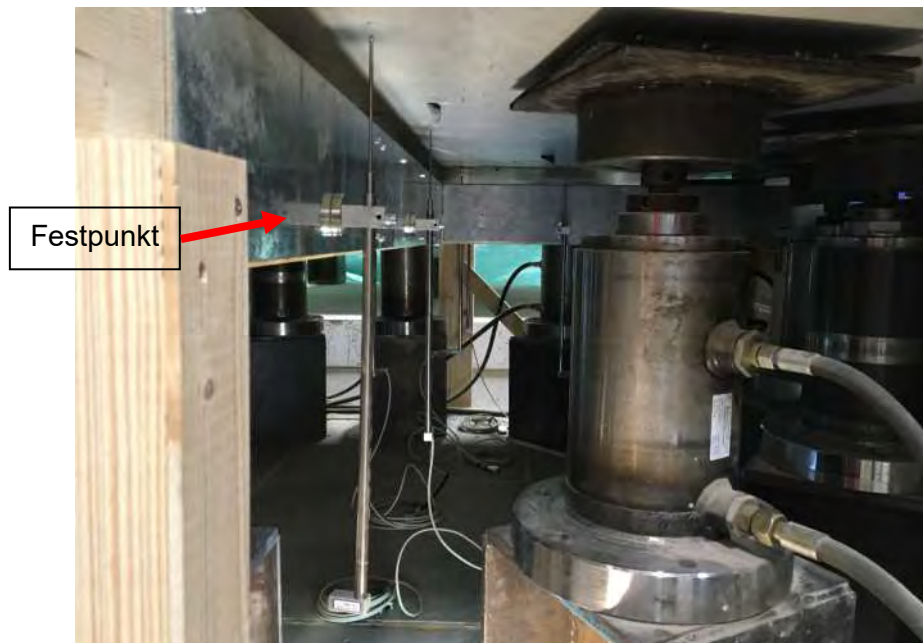
Wegaufnehmer im eingebauten Zustand
