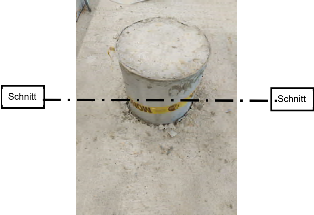
(Bemerkung: Der Stahlzylinder endete 1,0 cm oberhalb der Betonplatte)
