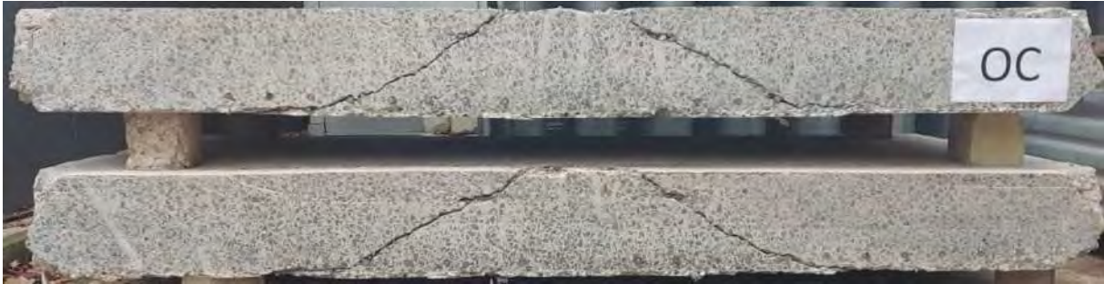
Rissverlauf im Schnitt
