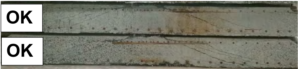
Rissverlauf im Schnitt
