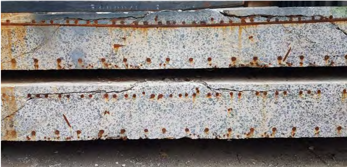
Rissverlauf im Schnitt
