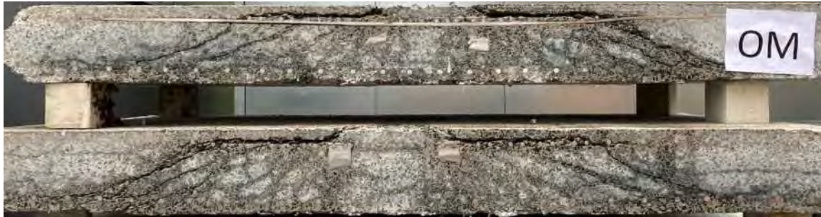
Rissverlauf im Schnitt
