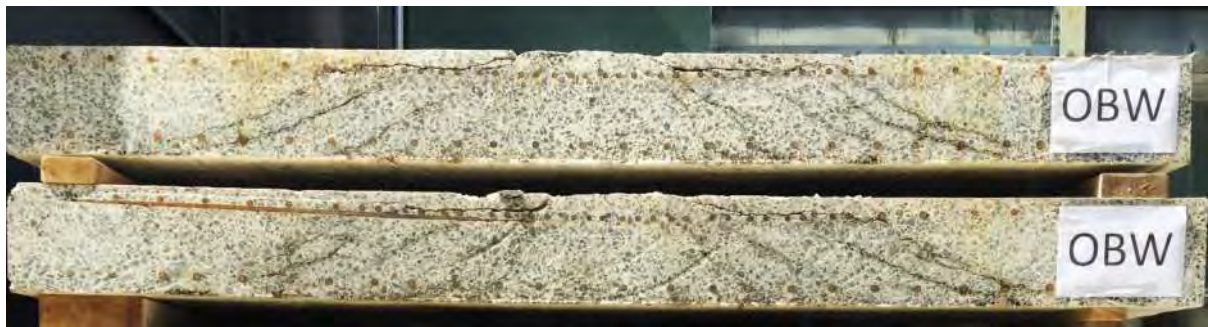
Rissverlauf im Schnitt
