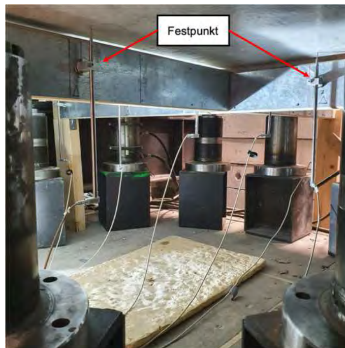
Wegaufnehmer im eingebauten Zustand
