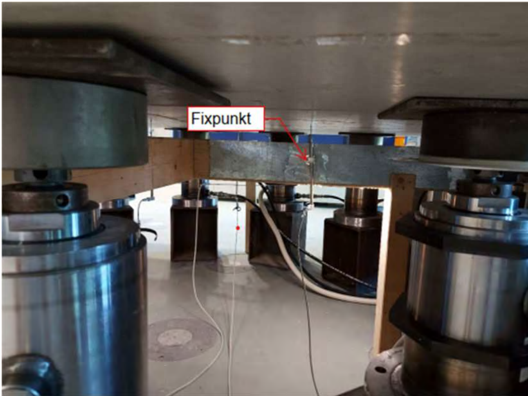
Wegaufnehmer im eingebauten Zustand
