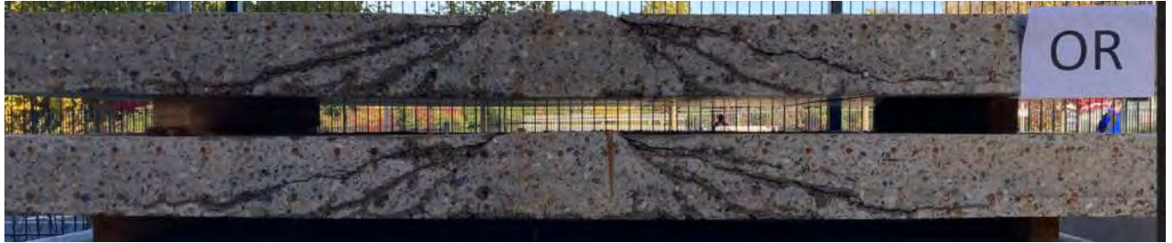
Rissverlauf im Schnitt
