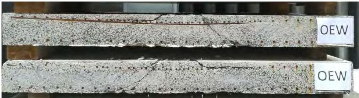
Rissverlauf im Schnitt
