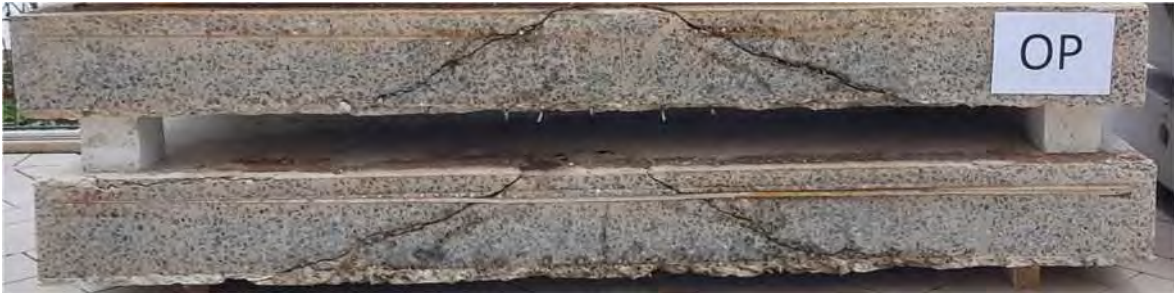
Rissverlauf im Schnitt
