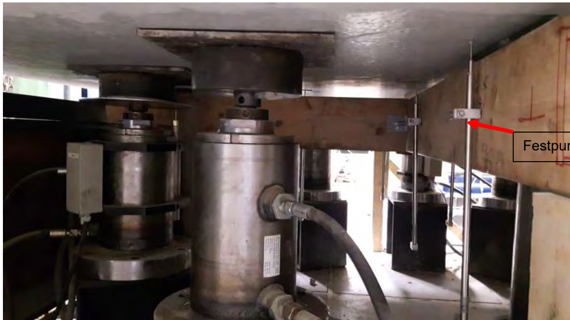
Wegaufnehmer im eingebauten Zustand
