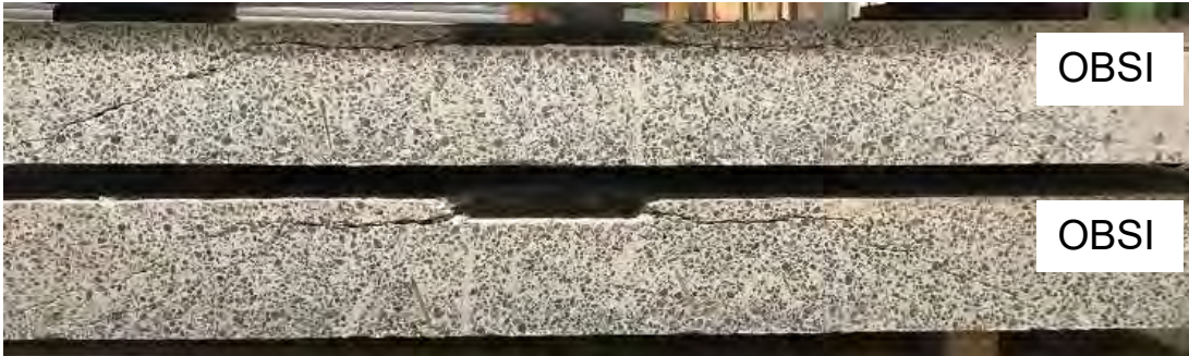
Rissverlauf im Schnitt
