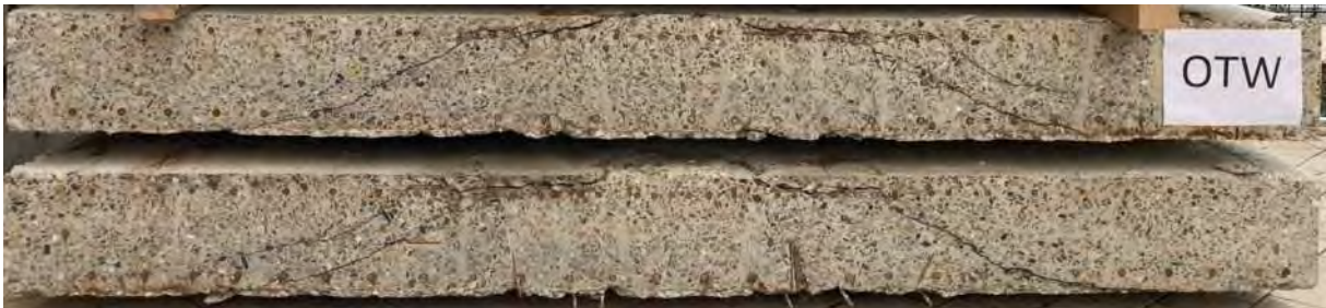
Rissverlauf im Schnitt
