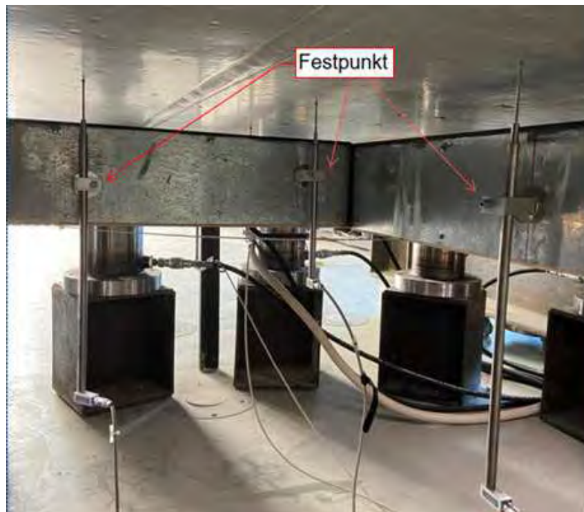
Wegaufnehmer im eingebauten Zustand
