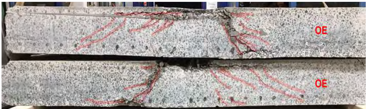
Rissverlauf im Schnitt
