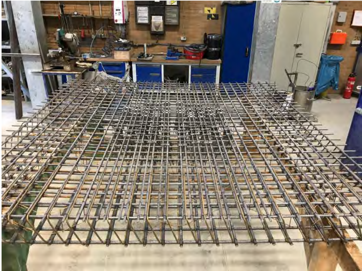
Bewehrung mit eingebauten L-Blechen
