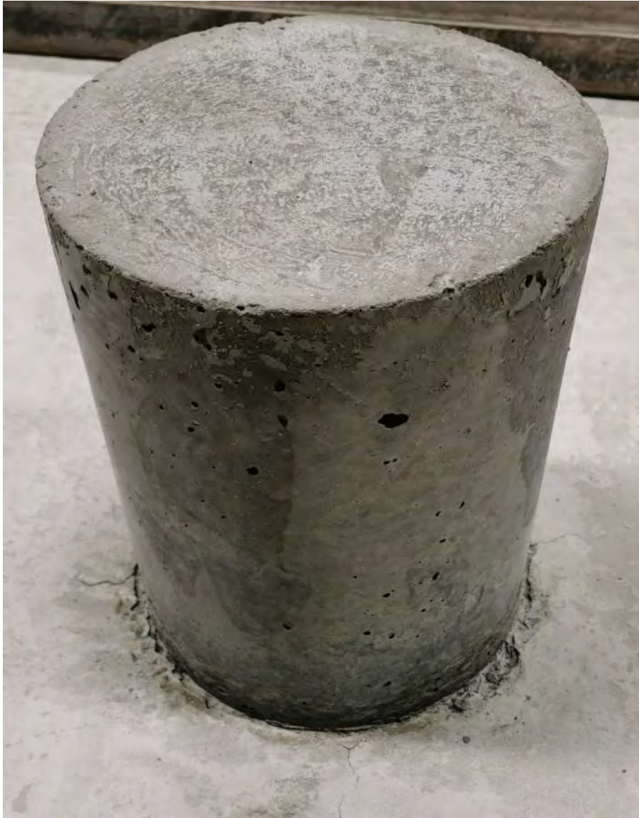
Rissverlauf um Stütze
