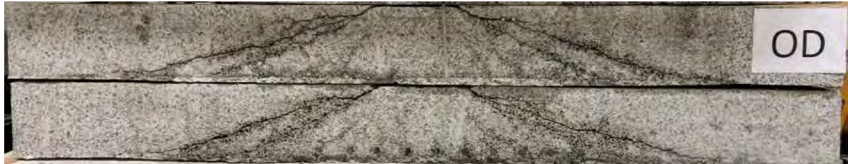
Rissverlauf im Schnitt
