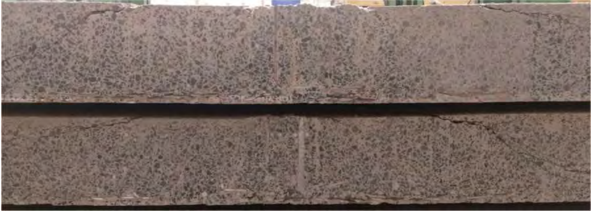
Rissverlauf im Schnitt
