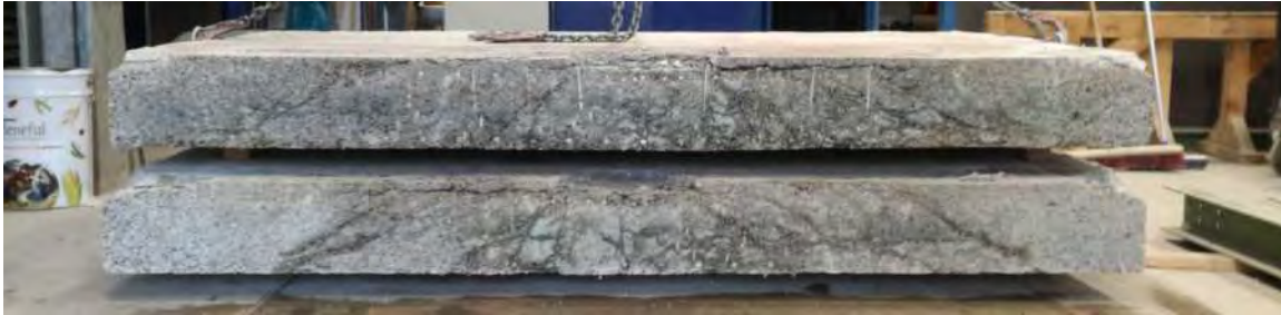
Rissverlauf im Schnitt
