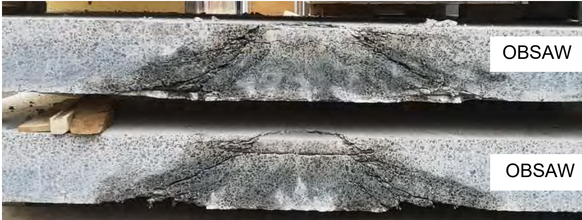
Rissverlauf im Schnitt
