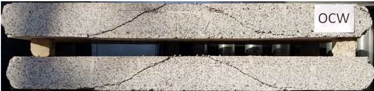
Rissverlauf im Schnitt
