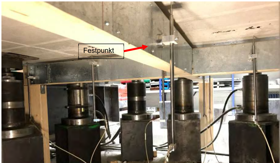
Wegaufnehmer im eingebauten Zustand
