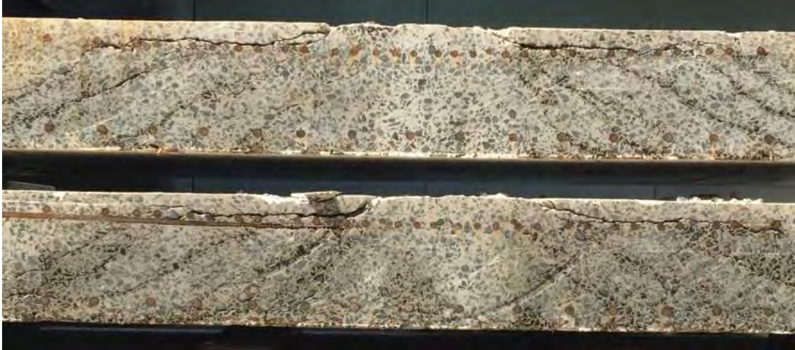
Rissverlauf im Schnitt
