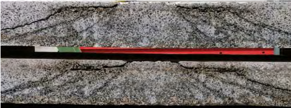
Rissverlauf im Schnitt
