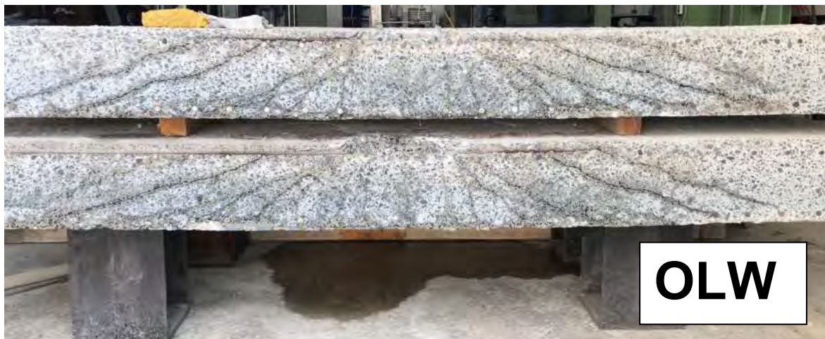
Rissverlauf im Schnitt
