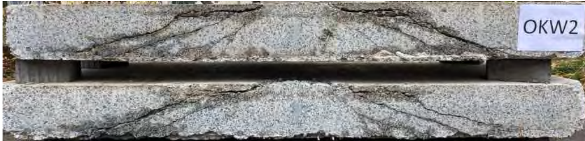
Rissverlauf im Schnitt
