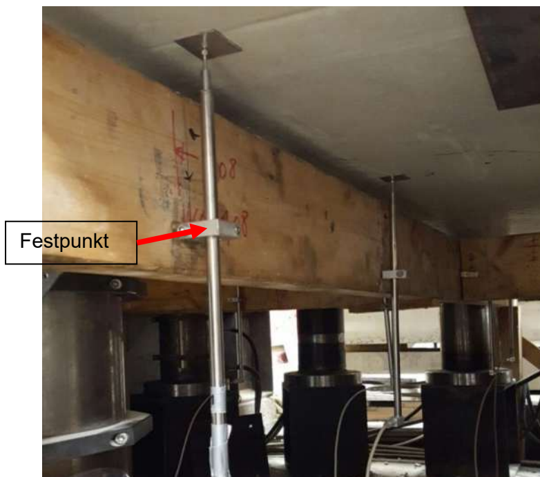
Wegaufnehmer im eingebauten Zustand
