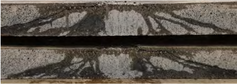
Rissverlauf im Schnitt
