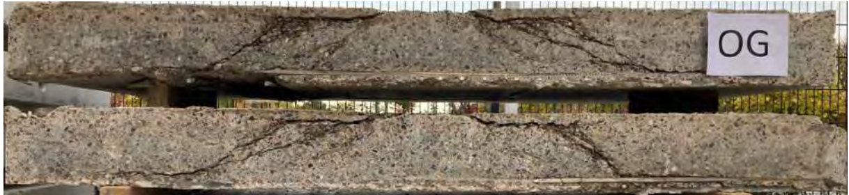
Rissverlauf im Schnitt
