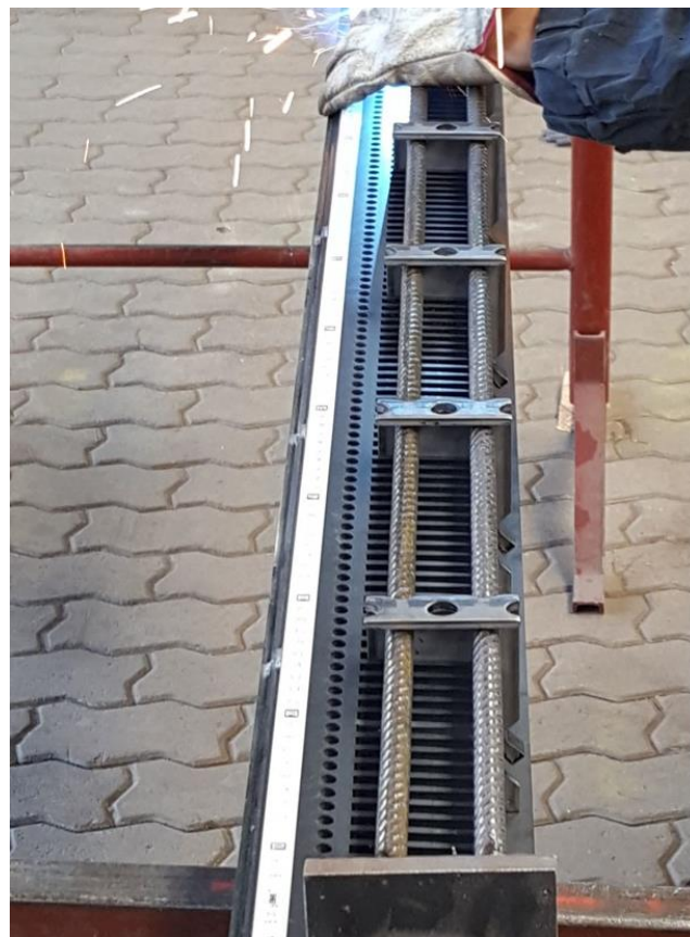
Bild 5 Zahnschiene zur einfachen Herstellung der Linienelemente vor Ort
