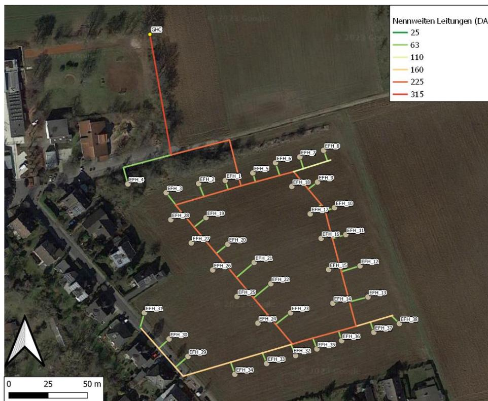
Abbildung 2.7: Untersuchungsgebiet A: Darstellung der Trassenführung und Rohrdimensionen (Außendurchmesser DA) nach hydraulischen Netzberechnungen
