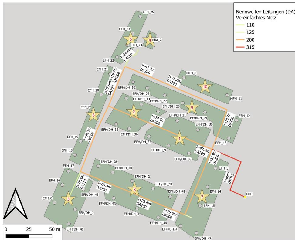
Abbildung 2.14: Untersuchungsgebiet B: Darstellung der Trassenführung und Rohrdimensionen (Außendurchmesser DA) im vereinfachten Netz für die Implementierung in das Simulationsmodell
