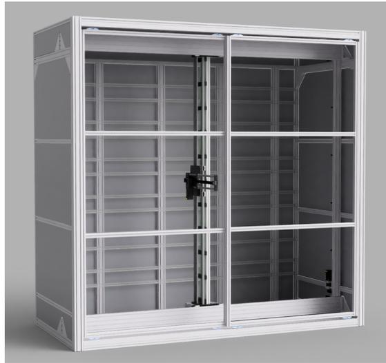
Abbildung 2.8: Rendering des MACRO-Schranks samt Portalroboter
