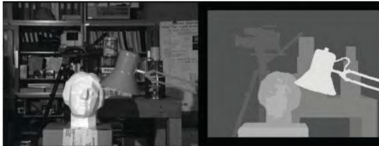
**Abbildung 2.6:** Darstellung eines normalen Bildes (links) in einer Tiefenkarte (rechts) (Quelle: <https://www.intechopen.com/chapters/67181>; Stand: 18.01.2022)
