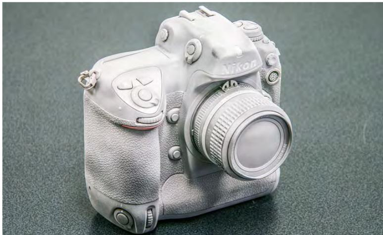
**Abbildung 3.1:** Objekt mit Scanspray besprüht, um Resultate zu verbessern (Quelle: <https://www.3d-grenzenlos.de/magazin/3d-scanner/aesub-blue-white-spray-transparente-objekte-27639683/>; Stand: 29.01.2022)
