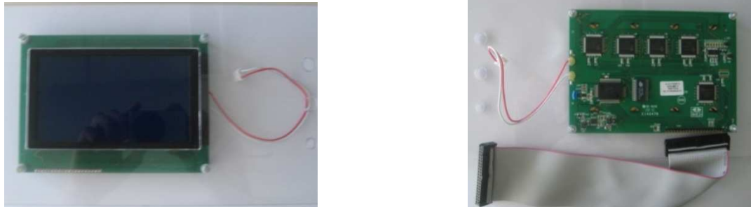
Abb.13: Grafikdisplay links(a) von oben rechts(b) von unten mit Datenbusleitung
