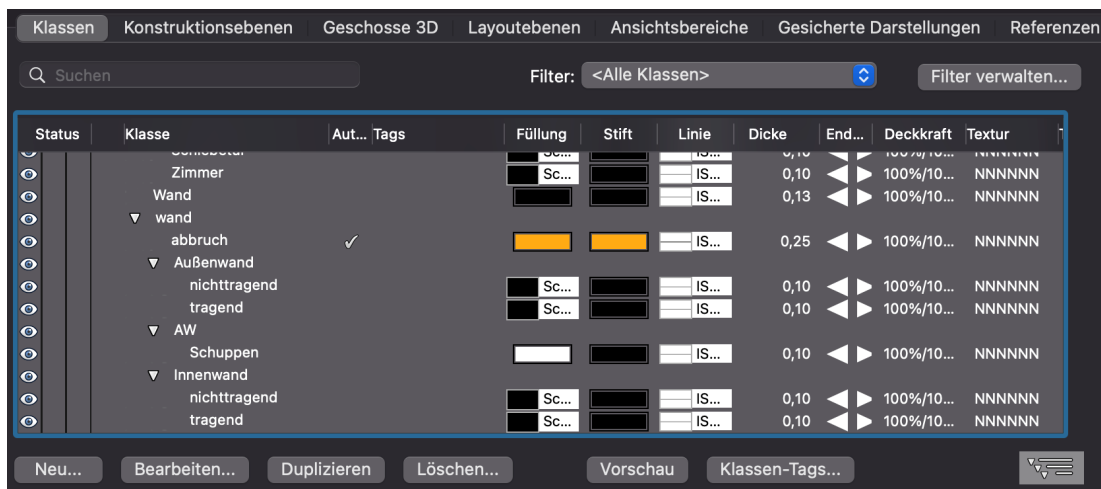
Abbildung 5.6: Ausschnitt der Klassenübersicht, der die hierarchische Struktur der Wände zeigt.
