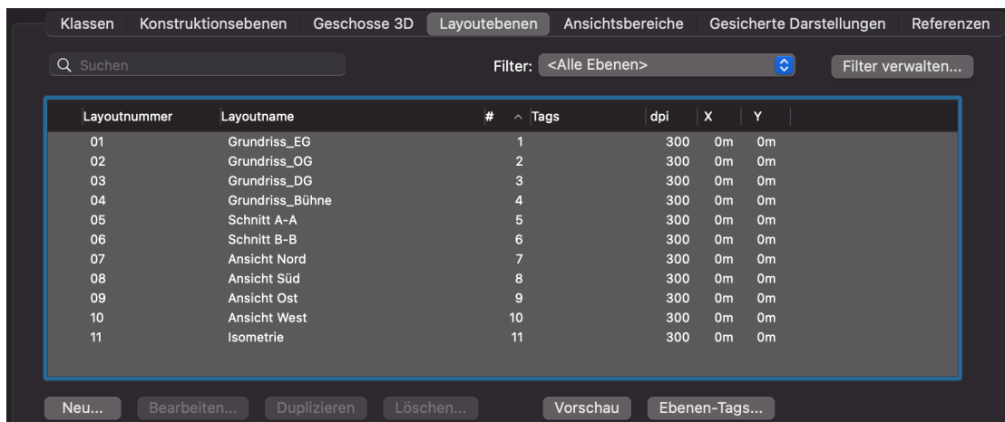
Abbildung 5.42: Reiter der Layoutebenen innerhalb der Organisation. Insgesamt wurden elf Layoutebenen erstellt, auf denen die Planableitungen platziert werden.
